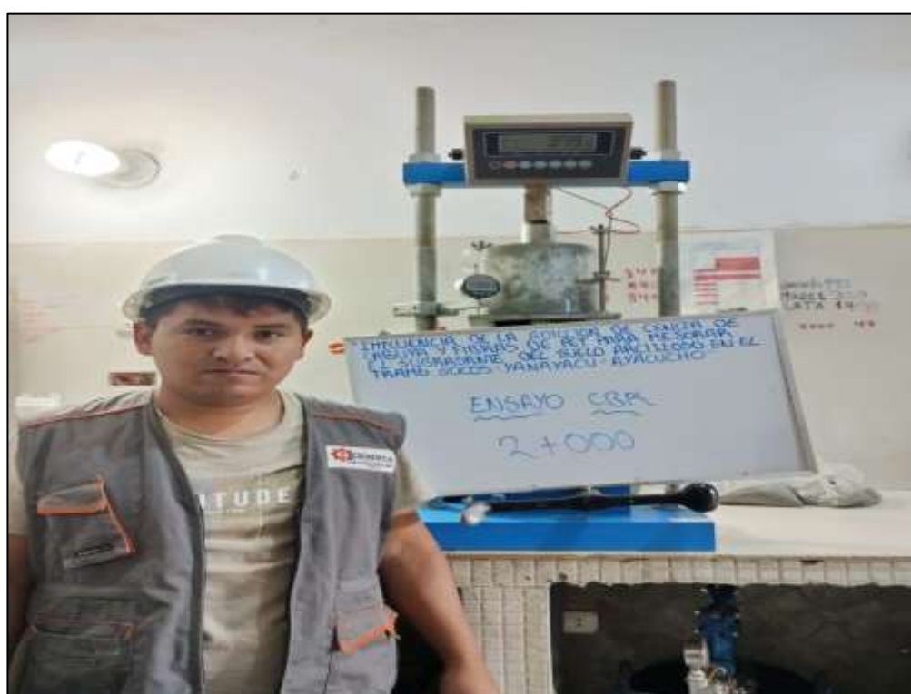
Fotografía 07: Ejecucion del ensayo CBR prog. 2+000
