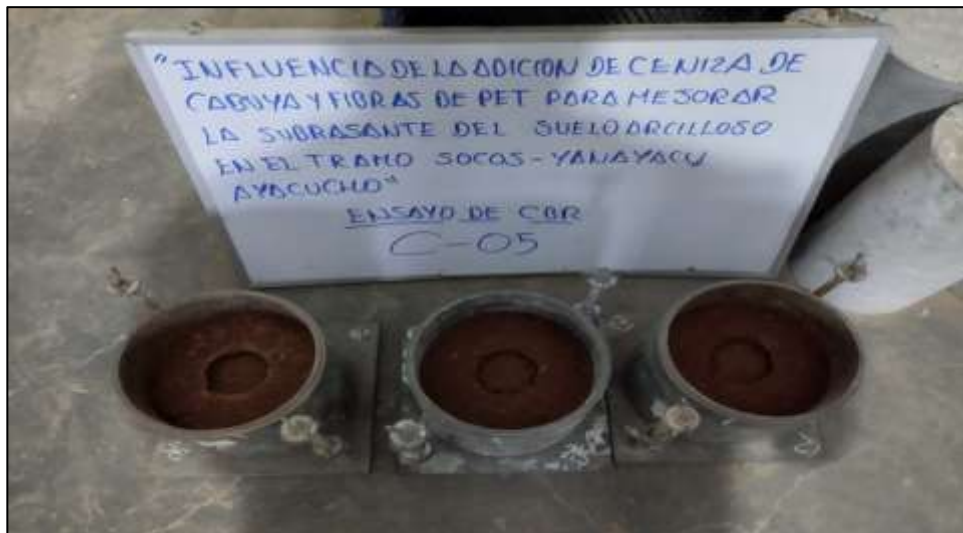
Figura 10. Ensayo de C.B.R.
