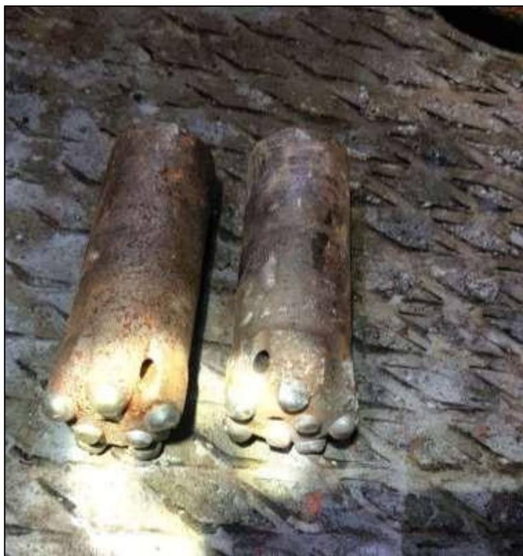
Fotografía 2. Broca rimadora de 45 mm de diámetro
