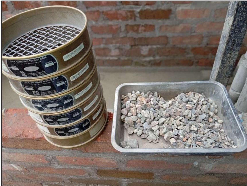
Anexo 36. Ensayo de granulometría de piedra chancada Huso #67.
