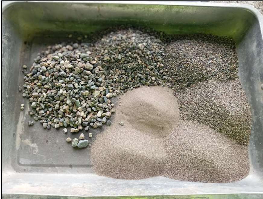
Anexo 36. Ensayo de granulometría de piedra chancada Huso #67.
