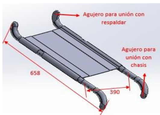
Figura 97. Estructura de asiento de silla de ruedas
