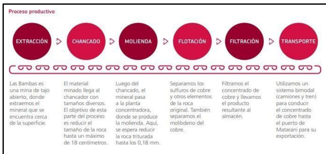
Figura 2. Diagrama esquemático de proceso productivo. Nota: Tomado de Informe de Sostenibilidad 2016 Las Bambas (2).
