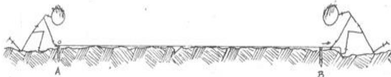
Muchas veces es necesario medir en terrenos cubiertos de pastos cortos, hojarasca, montículos de piedras y las irregularidades de la superficie del terreno no nos permite apoyar la cinta sobre el terreno; entonces para vencer dichos obstáculos es necesario el uso de una plomada pendular y jalones.
