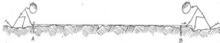
Muchas veces es necesario medir en terrenos cubiertos de pastos cortos, hojarascas, montículos de piedras y las irregularidades de la superficie del terreno no nos permite apoyar la cinta sobre el terreno; entonces para vencer dichos obstáculos es necesario el uso de una plomada pendular y jalones.
