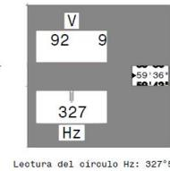
Teodolito Wild con micrómetro óptico
