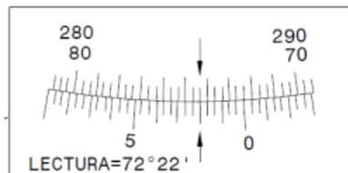
Los teodolitos difieren entre sí en cuanto a los sistemas y métodos de lectura. Existen teodolitos con sistemas de lectura sobre vernier y nonios de visual directa (figura).
