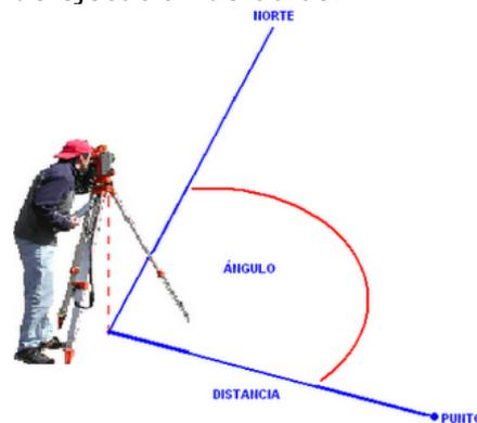
Una poligonal es una sucesión de líneas quebradas, conectadas entre sí en los vértices. Para determinar la posición de los vértices de una poligonal en un sistema de coordenadas rectangulares planas, es necesario medir el ángulo horizontal en cada uno de los vértices y a distancia horizontal entre vértices consecutivos.
