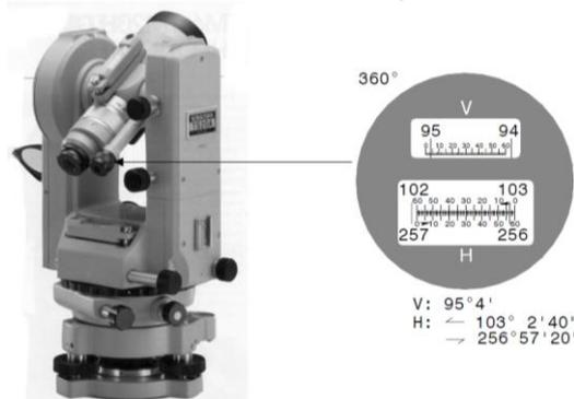
Teodolito Sokkia con microscopio lector de escala
