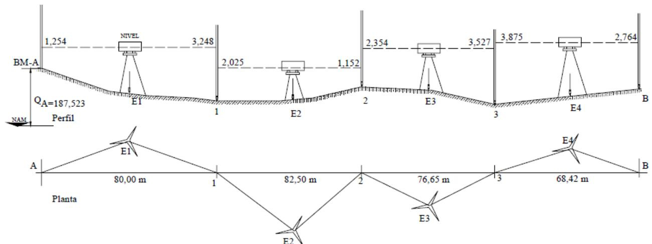
En la figura se han representado esquemáticamente el perfil y la planta de la nivelación a fin de recalcar que no es necesario que las estaciones estén dentro de la alineación, ya que lo importante es que estén equidistantes a los puntos de mira, a fin de eliminar el error de inclinación del eje de colimación.
