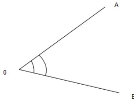
Estacionar el teodolito en el punto "0" visar al punto A con el limbo horizontal graduado en 0°0'0", girar al punto B, anotando el ángulo "w", en ésta posición bloquear el limbo horizontal y trasladar hasta la posición original A, soltar en esta posición el bloqueador de ángulo y volver a visar el punto B, siendo esta la segunda lectura w', continuar con el procedimiento las veces que sea necesario de acuerdo a la precisión deseada. El ángulo promedio se calculará con la siguiente relación.
