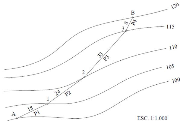
Para calcular las pendientes P1 a P4 del alineamiento AB, se requiere medir con el escalímetro y a la escala indicada, la distancia de cada uno de los tramos del alineamiento.
