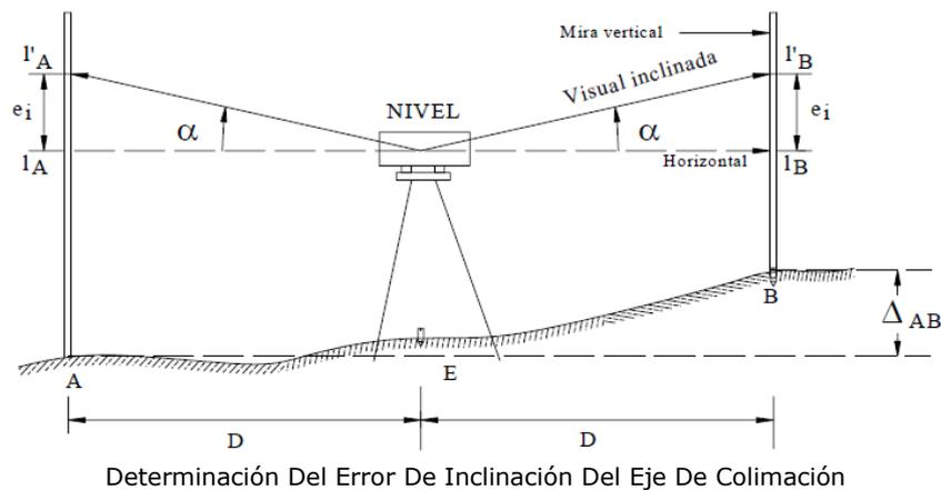
Estacionando el nivel en un punto E equidistante entre A y B, y colocando miras verticales en ambos puntos, tomamos lecturas a las miras. De existir error de inclinación, el eje de colimación estaría inclinado un ángulo  $\alpha$  con respecto a la horizontal, por lo que las lecturas a la mira serían  $l'_A$  y  $l'_B$ , generando el error de lectura  $e_i$ , igual para ambas miras por ser distancias equidistantes a la estación.
