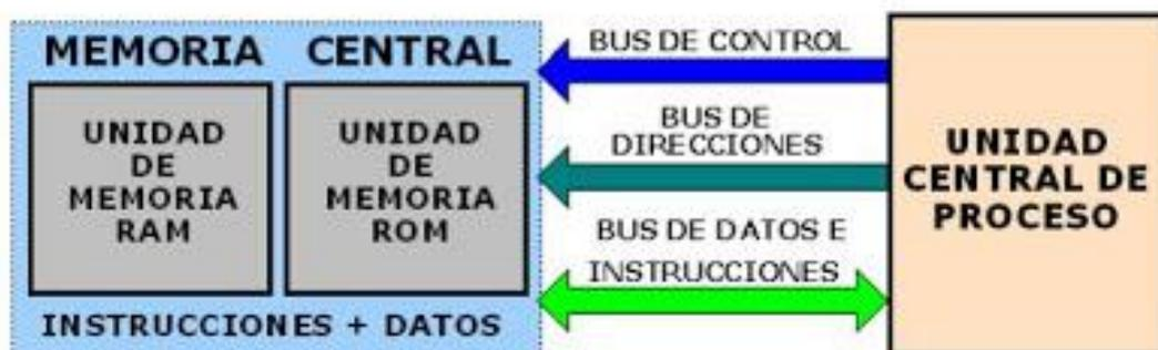
En un sistema con **arquitectura Von Neumann** el tamaño de la unidad de datos o instrucciones está fijado por el ancho del bus que comunica la memoria con la CPU. Así un microprocesador de 8 bits con un bus de
