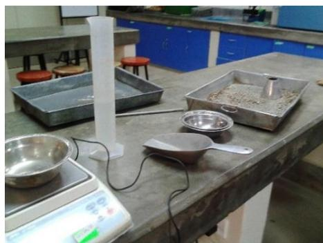
Paso 6: Pesar la muestra y calcular el peso específico y absorción.
