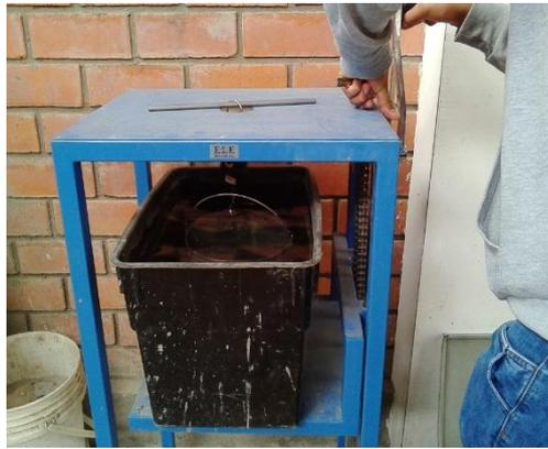
Paso 4: Llenar la muestra en la canastilla sumergida en el agua.
