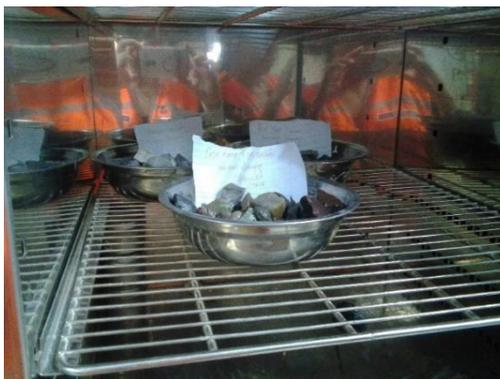
Paso 6: Llevar la muestra al horno durante 24 horas, pesar y calcular.
