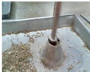
Paso 3: Compactar la muestra en forma circular utilizando el pizon metálico.
