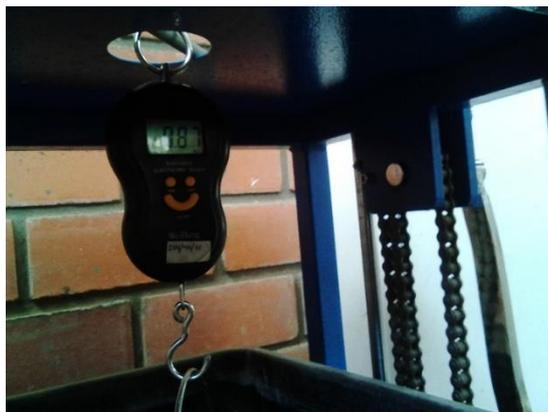
Paso 5: Medir el peso de la muestra sumergida en el agua.
