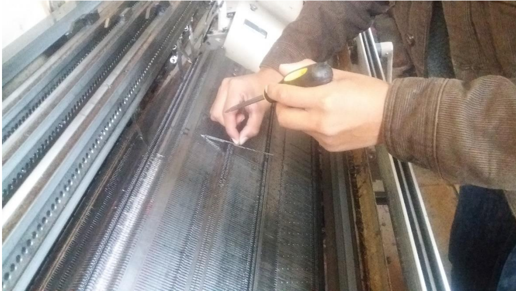
Figura 34: Identificando averías en la MÁQUINA DE TEJER CNC 1 001T-STOLL - II
