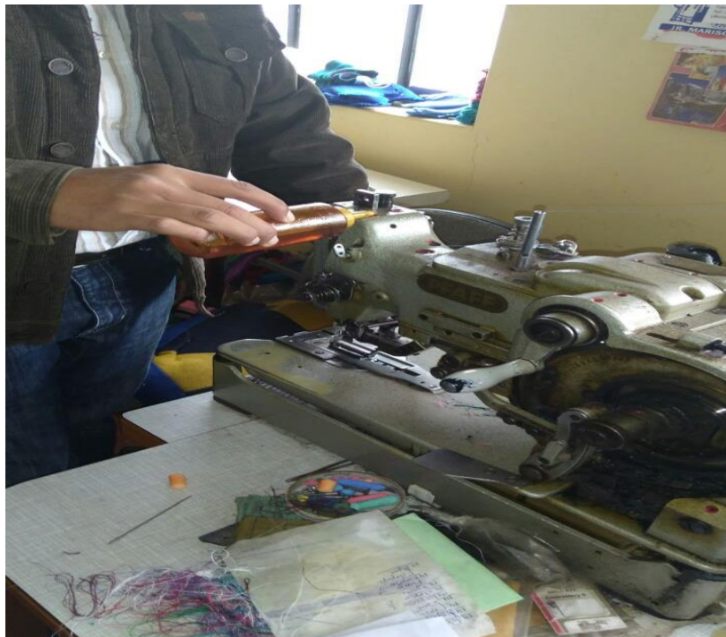
Figura 38: Proceso de mantenimiento en la MÁQUINA OJALADORA 1 001OJA-PFAFF
