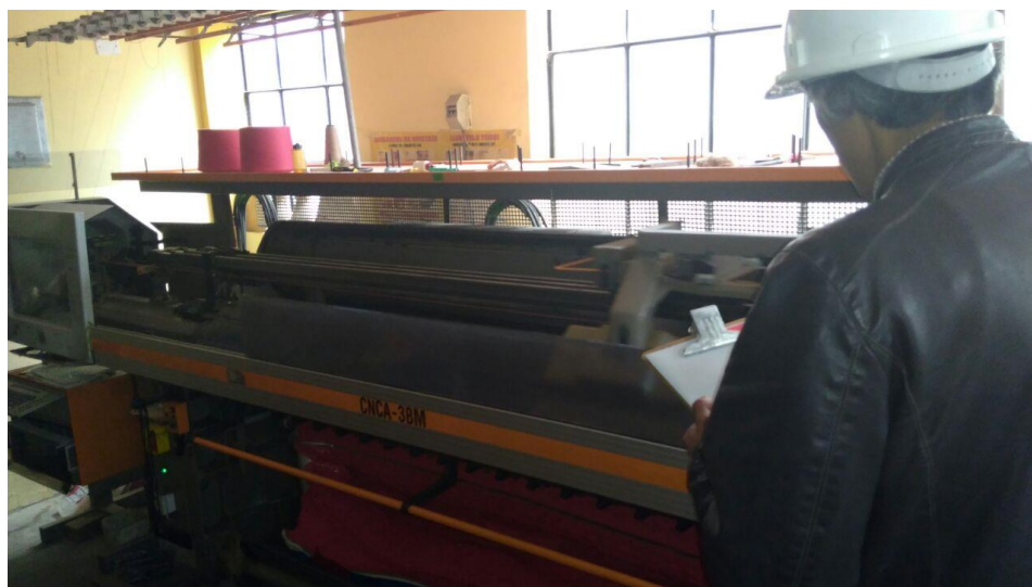
Figura 36: Realizando inspecciones en la MÁQUINA DE TEJER CNCC 2 001T-STOLL - I
