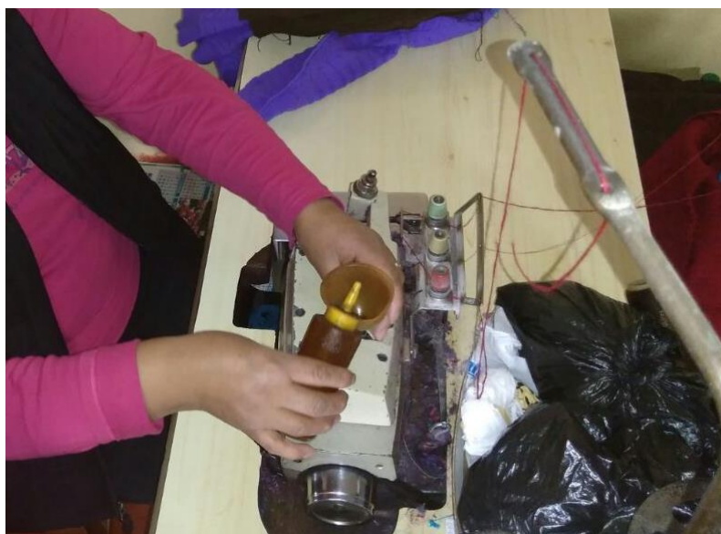
Figura 39: Proceso de mantenimiento en la MÁQUINA REMALLADORA 2 002R-UNIÓN ESPECIAL
