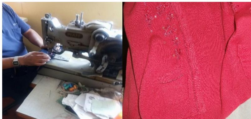
Figura 15: Proceso de ojalado y corte de ojales.
