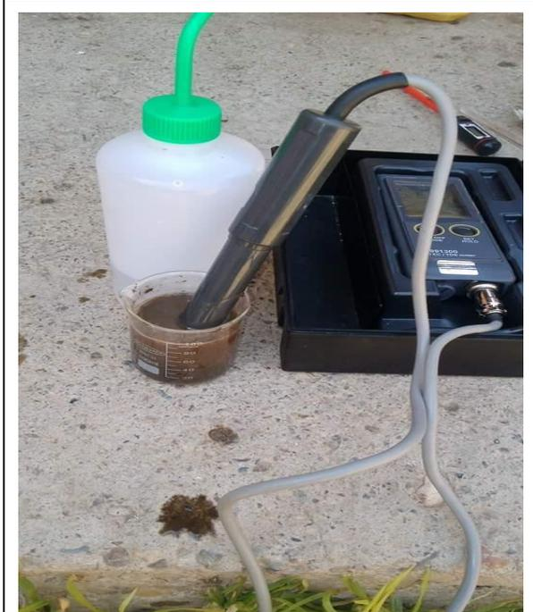
**Fotografía N° 52. Medición de conductividad eléctrica in situ.**
