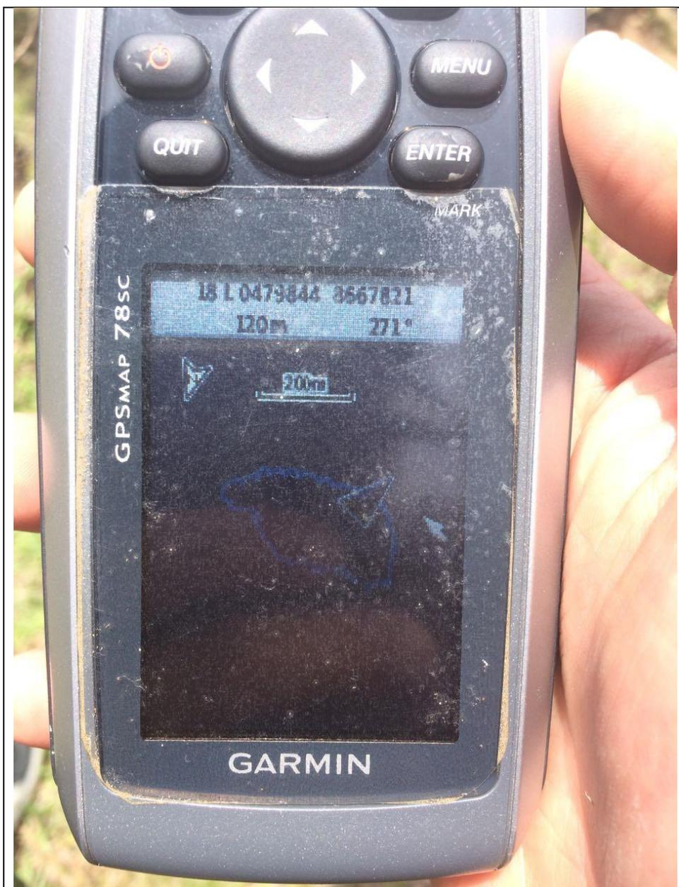
Fotografía 10. Georreferenciación de recorrido del área afectada por la quema, con el uso de GPS. Huancayo: “Corona del Fraile”.
