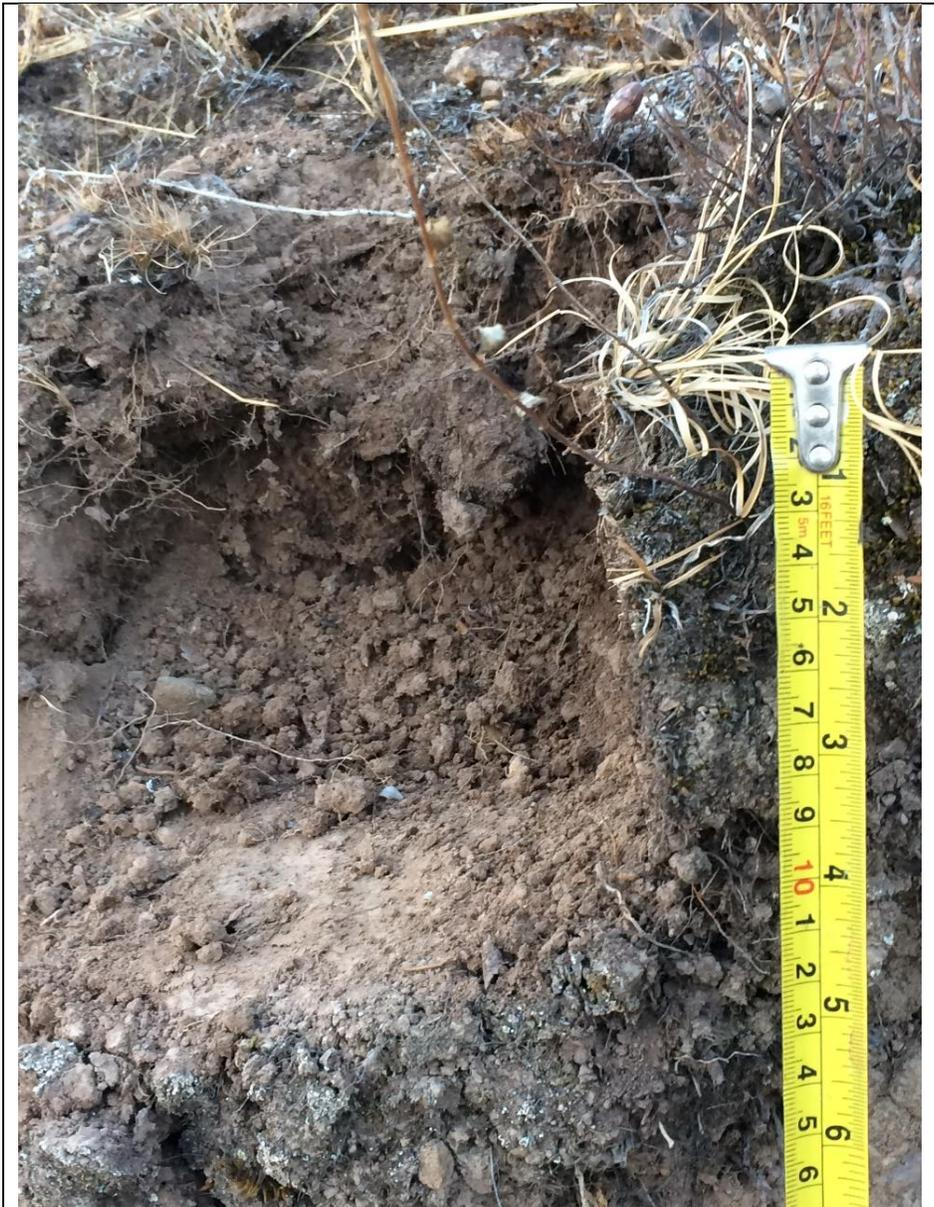
Fotografía 6. Muestreo del suelo según profundidad. Huancayo: “Corona del Fraile”.
