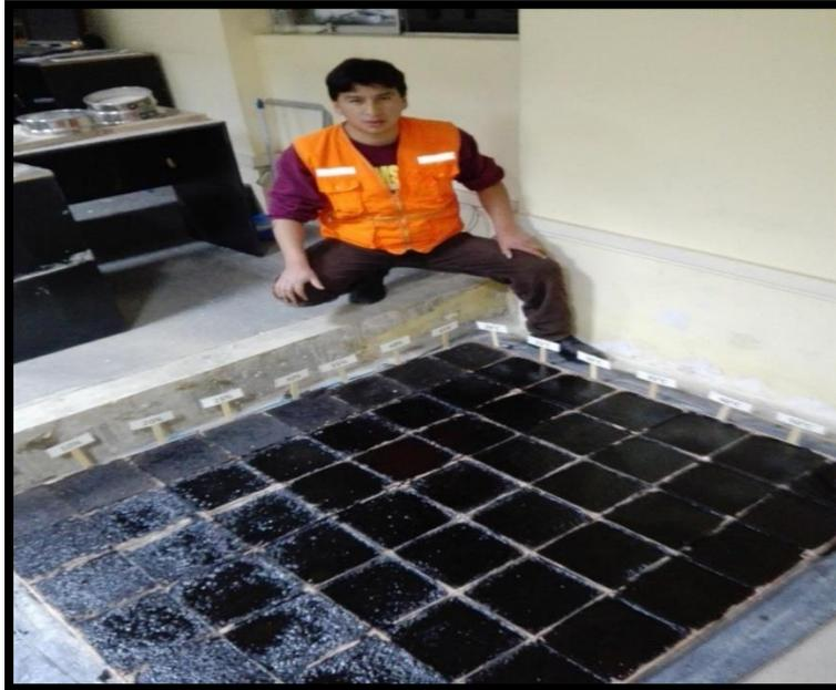
**Figura 25: Culminación del proceso de imprimado asfáltico.**
