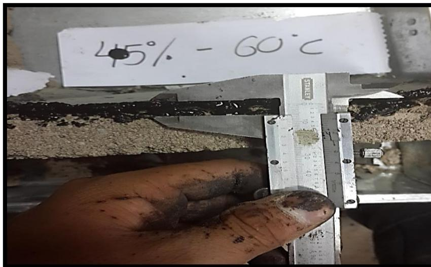
**Figura 88: Penetración al 45% finos con 60°C de la emulsión asfáltica.**
