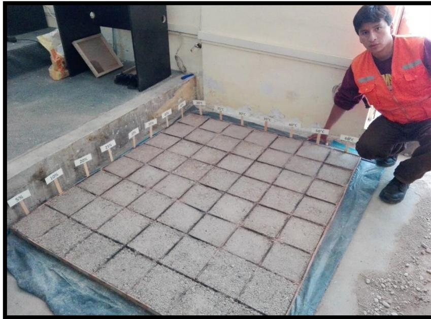
Foto 19: Moldes enumerados según % de finos y temperaturas.
