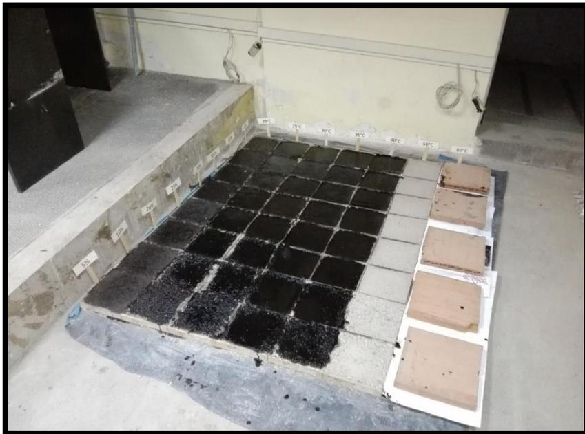
Foto 32: Aplicación de la emulsión asfáltica a 50°C.
