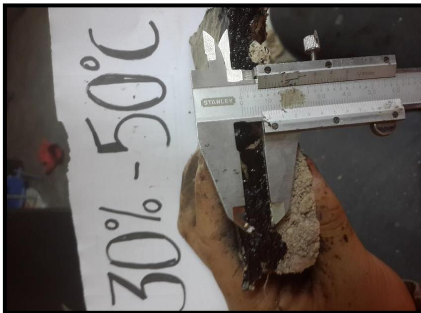
**Figura 29: Penetración al 30% de finos con 50 °C de temperatura.**
