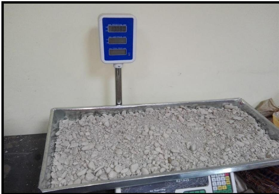
Foto 12: Peso del agregado grueso para la posterior mezcla.
