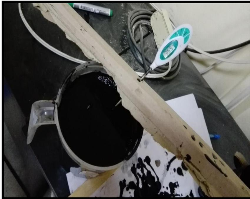
Foto 27: Temperatura de la emulsión asfáltica a 35°C.
