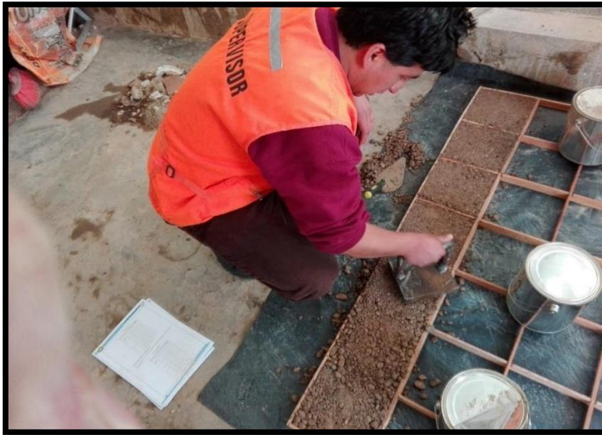
**Figura 20: Compactado del material a 5% de finos.**
