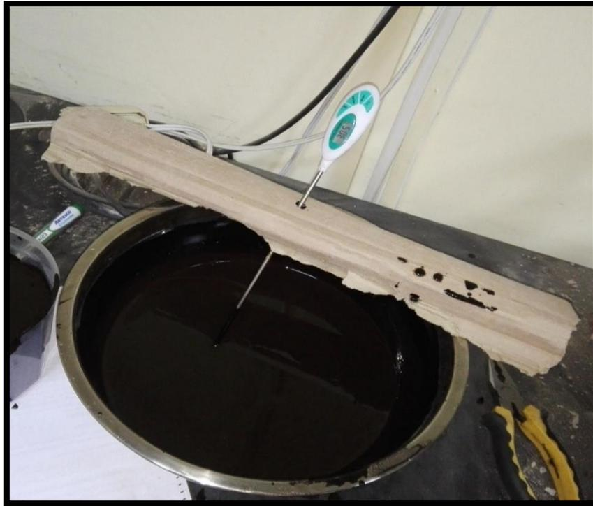
Foto 25: Temperatura de la emulsión asfáltica a 30°C.
