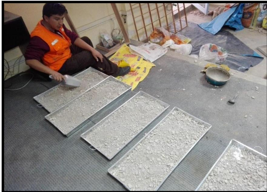
Foto 14: Mezclado del material en diferentes bandejas.
