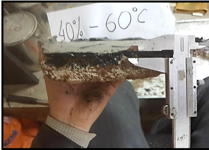
**Figura 83: Penetración al 40% de finos con 60°C de la emulsión asfáltica.**
