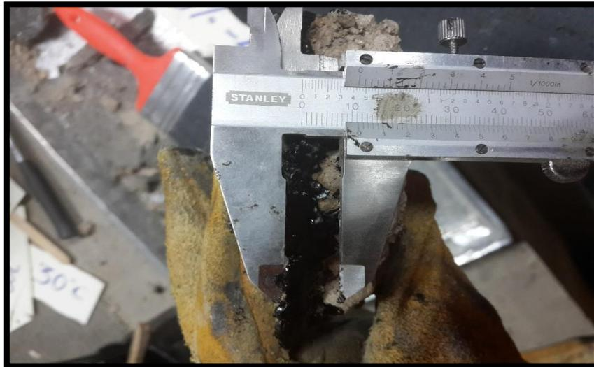
**Figura 26: Medición de la altura de penetración del imprimado asfáltico.**
