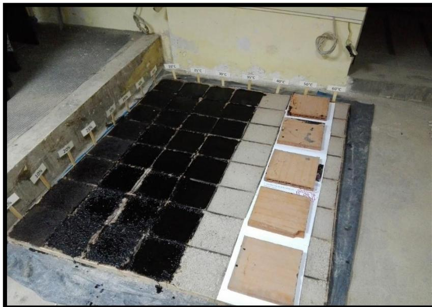
Foto 28: Aplicación de la emulsión asfáltica a 35°C.
