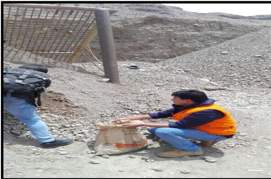
Foto 2: Toma de muestras del material granular de Cantera.
