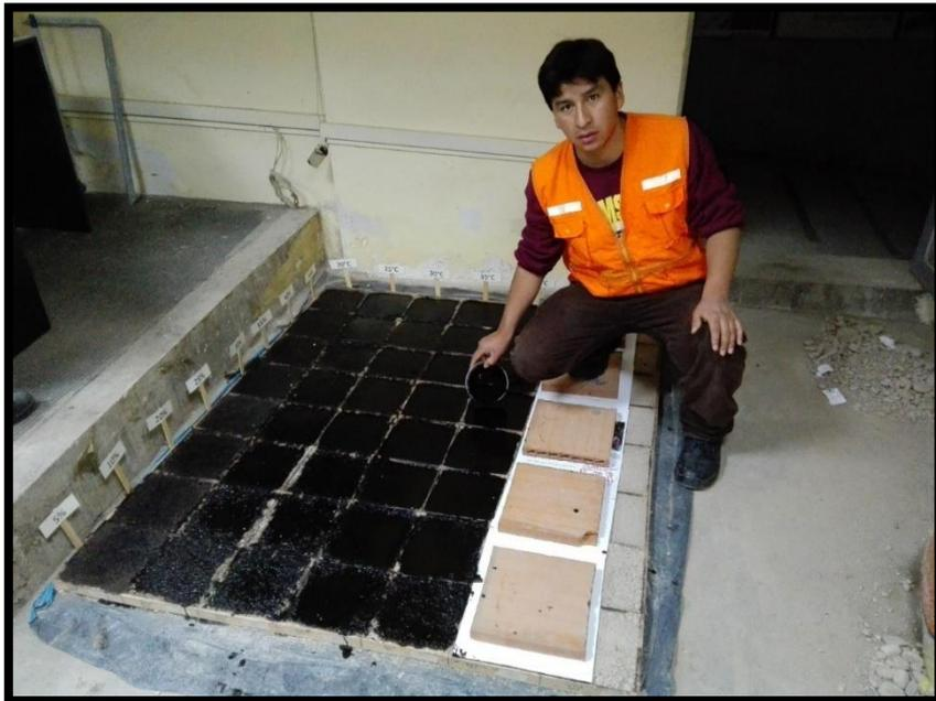
Foto 30: Aplicación de la emulsión asfáltica a 40°C.
