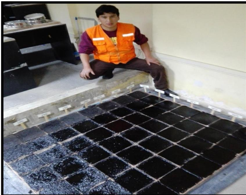
Foto 34: Riego de imprimación asfáltica a los 56 moldes.
