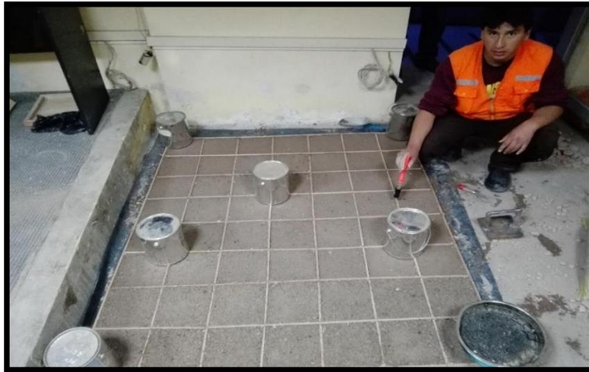
**Figura 21: 56 moldes según variaciones de agregados finos.**
