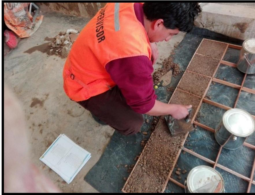
Foto 15: Compactado de la mezcla en los moldes cuadrados.
