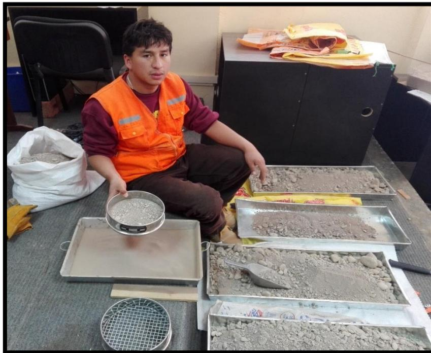
**Figura 17: Tamizado de material con la malla #16.**
