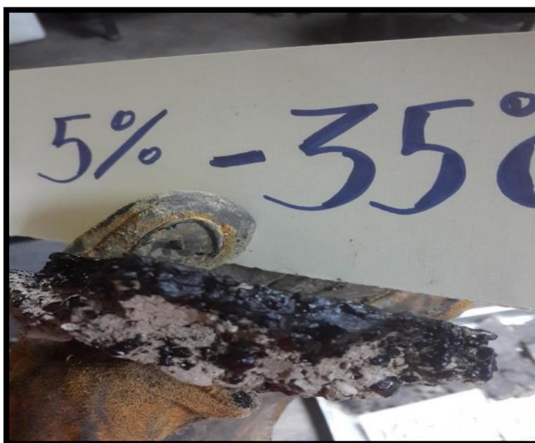
Figura 38: Penetración al 5% de finos con 35°C de la emulsión asfáltica.
