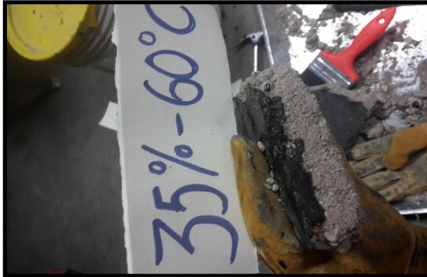
**Figura 28: Penetración al 35% de finos con 60°C de temperatura.**
