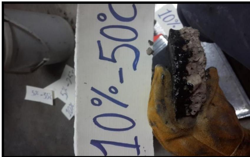
**Figura 27: Penetración al 10% de finos con 50°C de temperatura.**
