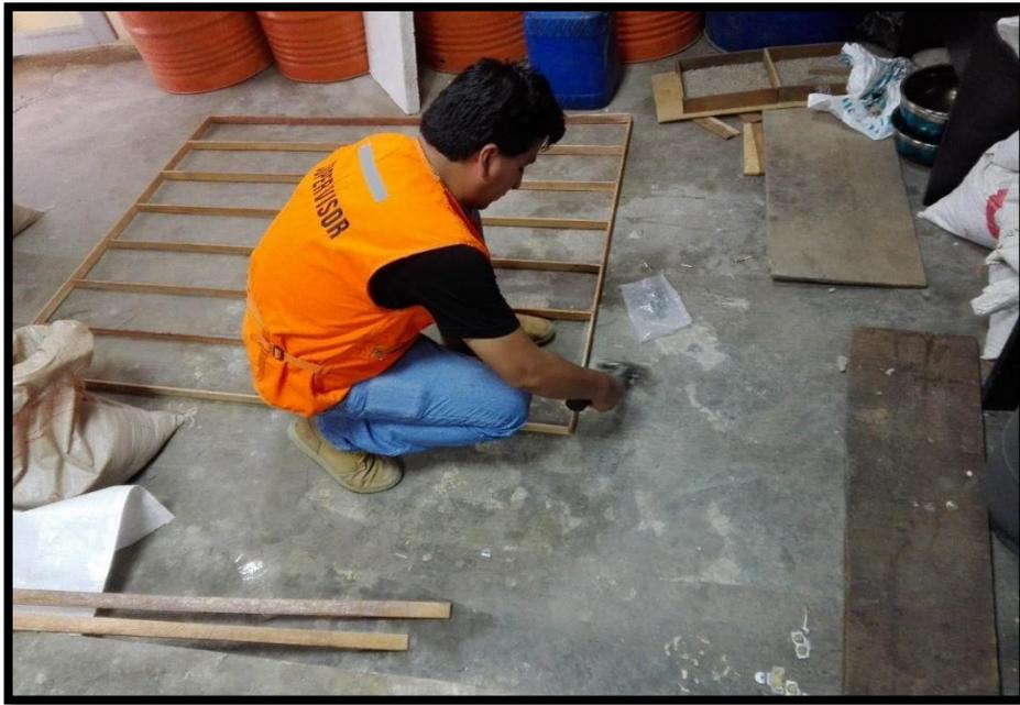
Foto 5: Construcción de moldes para la muestra.
