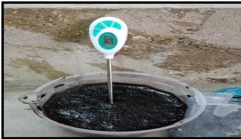
Figura 23: Medición de la temperatura de la emulsión asfáltica.
