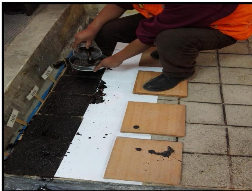
Foto 22: Aplicación de la emulsión asfáltica a 20°C.
