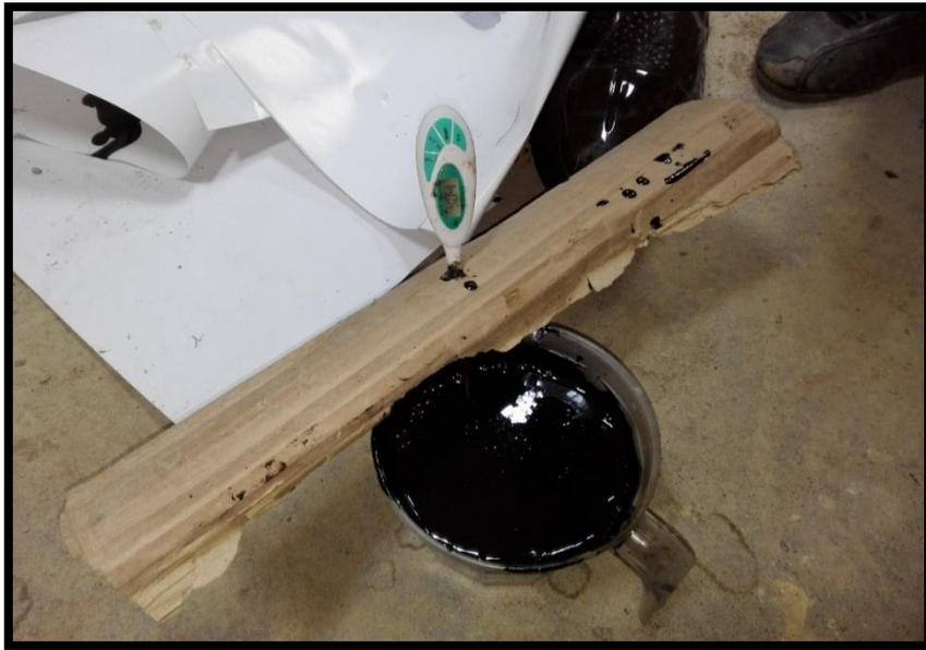
Foto 29: Temperatura de la emulsión asfáltica a 40°C.
