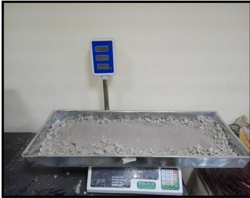
Foto 13: Mezcla del agregado grueso y fino para 1 molde.
