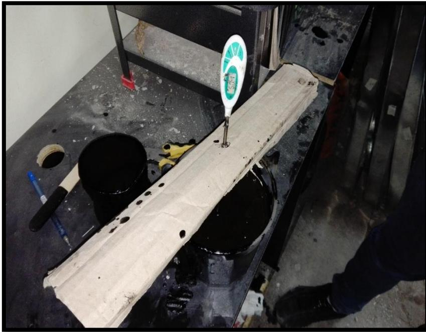
Foto 31: Temperatura de la emulsión asfáltica a 50°C.
