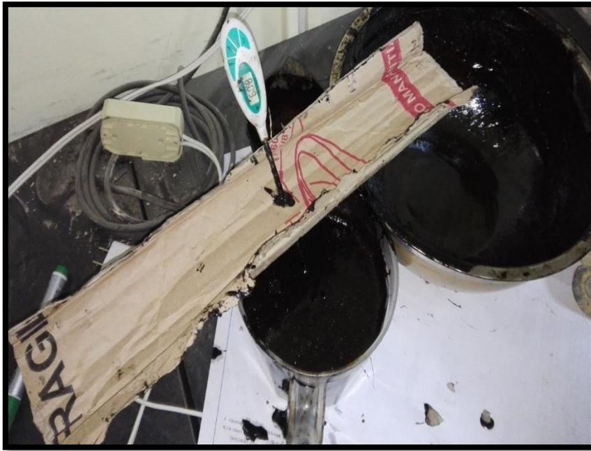
Foto 33: Temperatura de la emulsión asfáltica a 60°C
