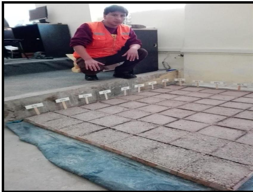
Foto 18: Moldes secos listos para aplicar la emulsión asfáltica.
