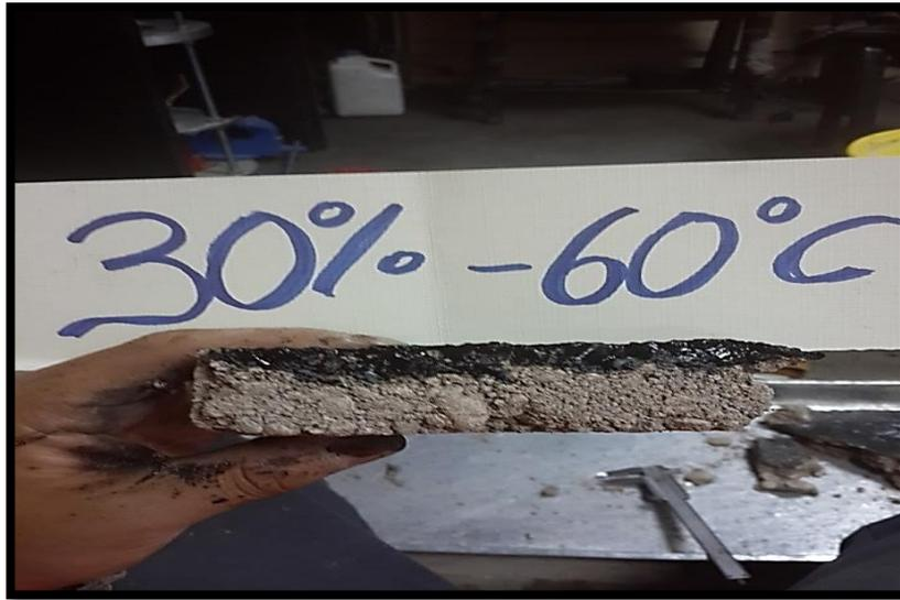
Figura 70: Penetración al 30% de finos con 60°C de la emulsión asfáltica.
