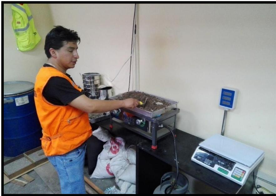
Foto 4: Uniformidad en el proceso de secado del material.
