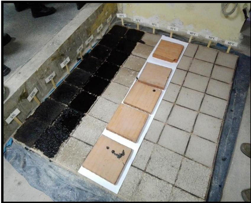
Foto 24: Aplicación de la emulsión asfáltica a 25°C sobre los moldes.
