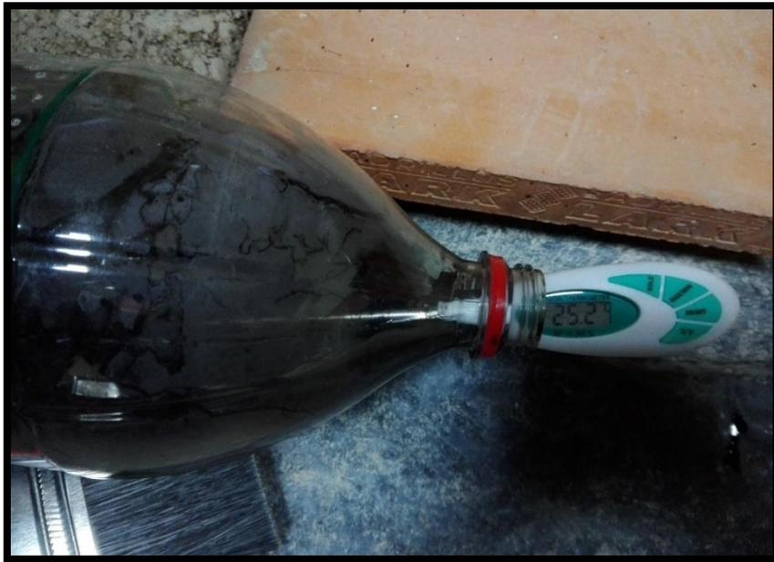
Foto 23: Temperatura de la emulsión asfáltica a 25°C.
