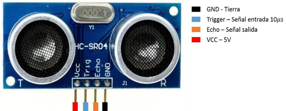
**Figura 27: Sensor Ultrasonido.**
