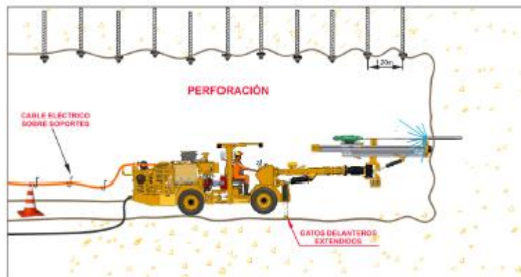
Figura 18. Estacionamiento de la máquina para la perforación
