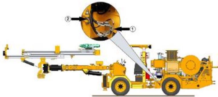
Figura 20. Ubicación de la válvula progresiva y punto principal Fuente: Manual de Mantenimiento Bolter 88 Jmc-263. Resemin S.A. 2016
