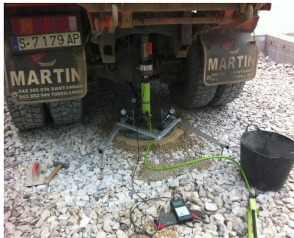
Figura 37: Ensayo de placa de carga.
