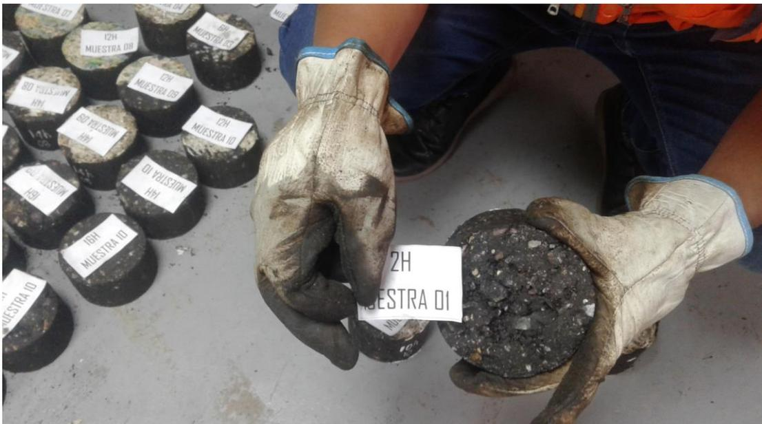
Foto 24: Muestra 1 compactado a 2 horas, se observa que el espécimen tiene buena consistencia.
