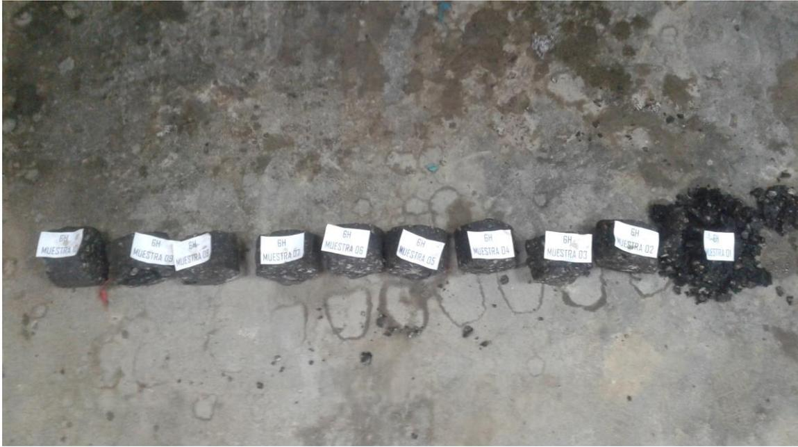
Foto 25: Muestras roturadas a 2 horas.
