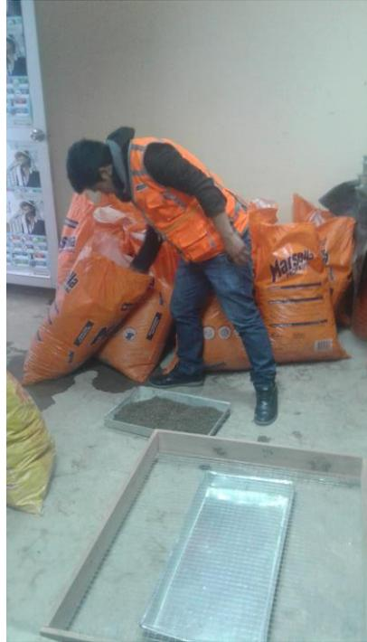
Foto 3: Vaciado de material mojado en bandejas para ser llevado al horno.
