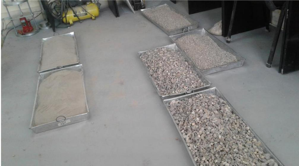
Foto 9: Primera etapa de material tamizado por tamaños nominales para ser mezclado y ensayado.
