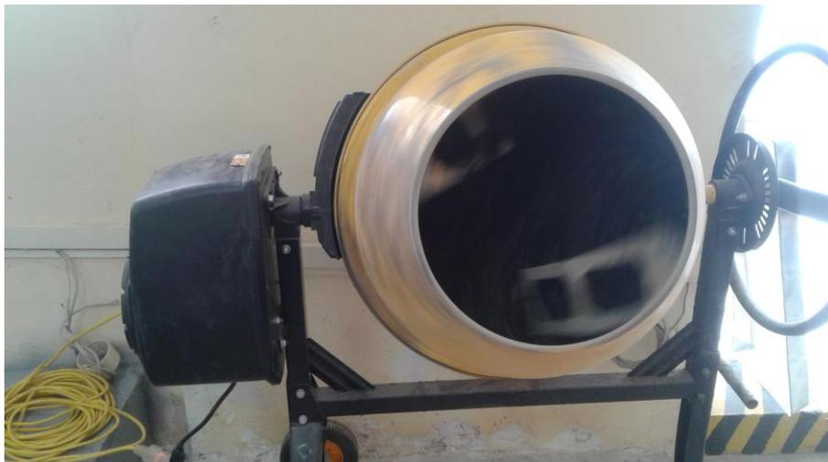
Foto 14: Mezclado del material tamizado y la emulsión asfáltica en el trompito, hasta encontrar una mezcla homogénea.
