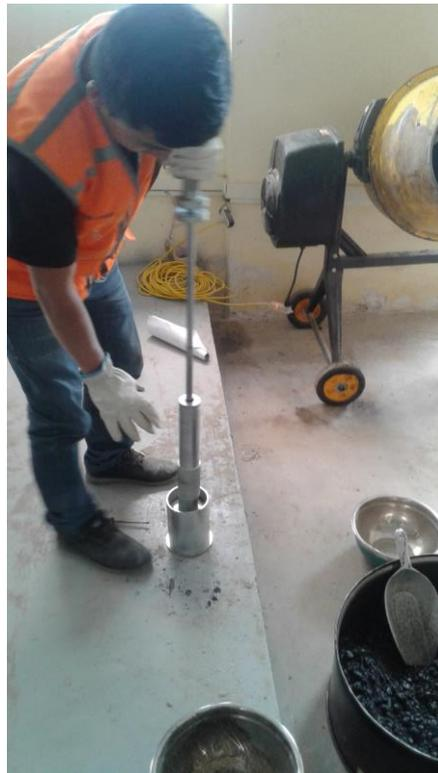
Foto 18: Ensayo de Marshall de acuerdo a los intervalos de tiempos.
