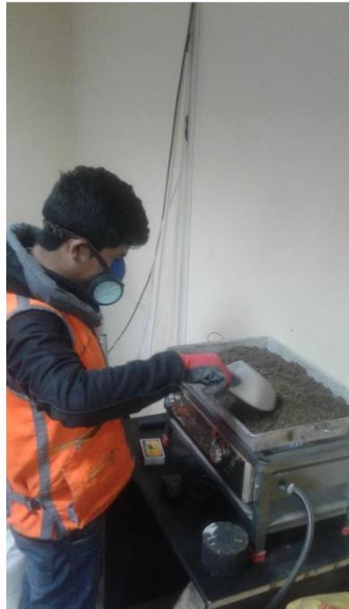
Foto 4: Secado del material fino para ser tamizado.
