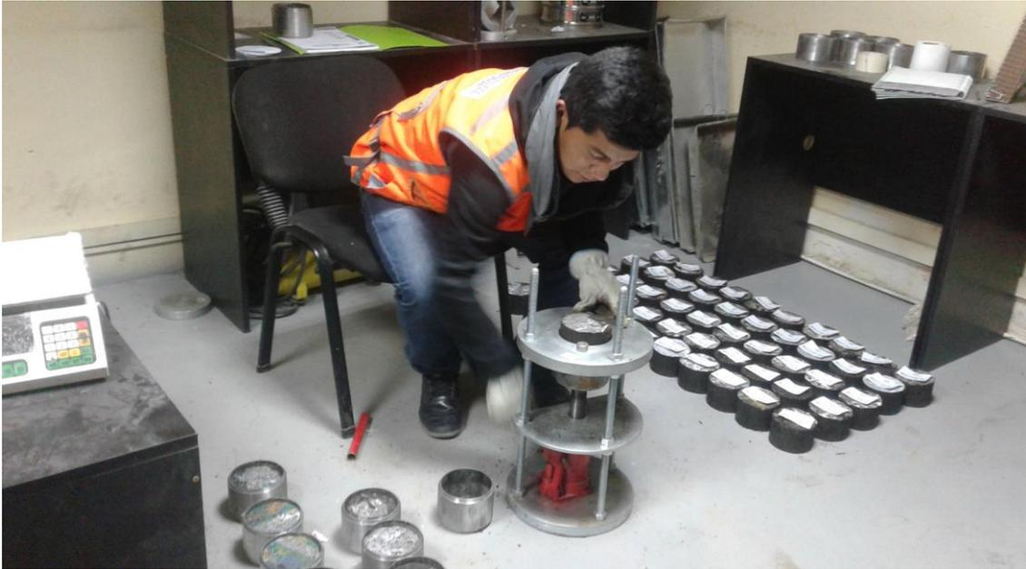
Foto 19: Desmolde de las briquetas para extraer el espécimen a las 10 horas.
