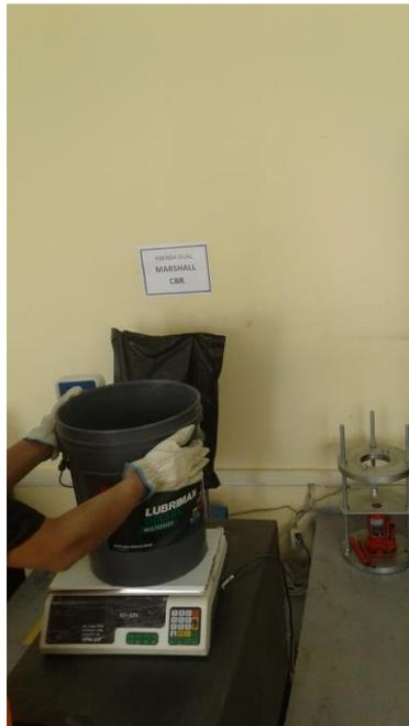
Foto 12: Pesado de la emulsión asfáltica CSS-1h.
