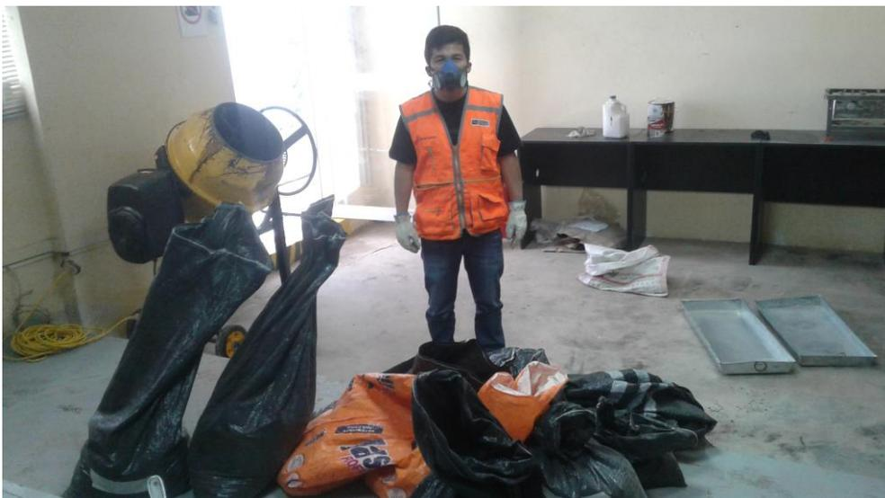
Foto 10: Total de material por tamaños nominales requeridos por la norma para ser mezclado y ensayado.
