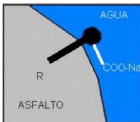
*Figura 4.* Glóbulos de cemento asfáltico en fase acuosa.
