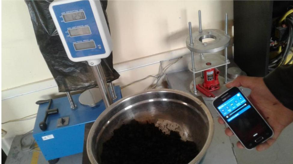
Foto 17: Pesado 1250 gramos de material para ser ensayado y ser colocado en las briquetas.
