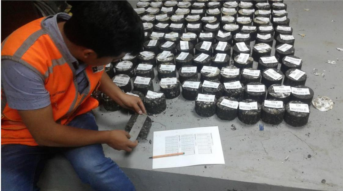
Foto 23: Medición de la altura de todos los especímenes para realizar las correcciones.
