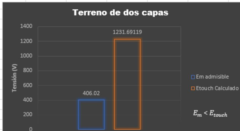
**Figura 41. Protección en condiciones modificadas tensión de toque**
