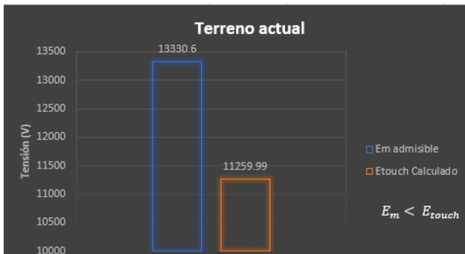
**Figura 39. Protección en condiciones naturales tensión de toque**
