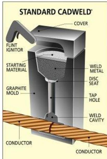
*Figura 15. Molde de soldadura exotérmica
