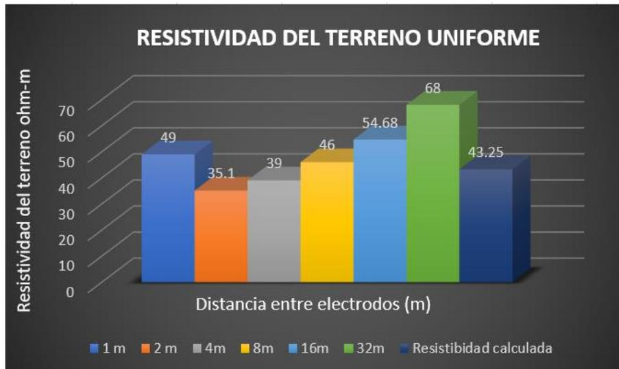
*Figura 38. Resistividad del terreno uniforme proyectado para la SE H1
