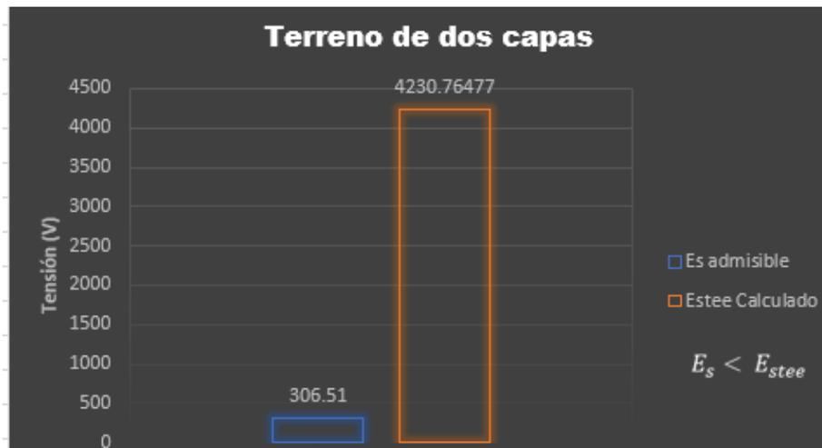
*Figura 42. Protección en condiciones modificadas tensión de paso
