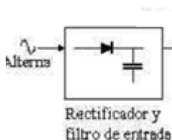
Figura 26: bloque del rectificador ELC P501 Fuente: EATON
