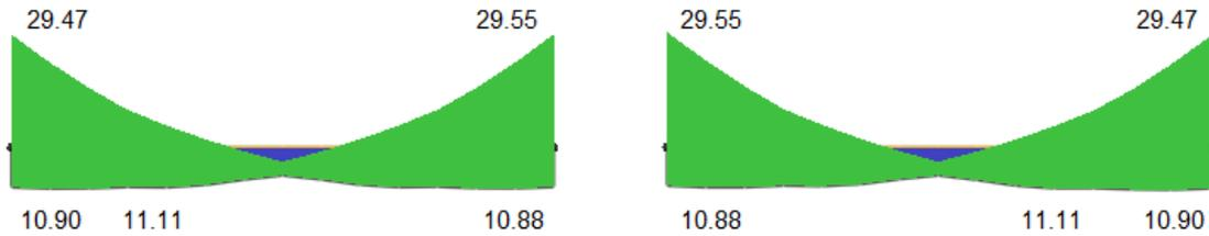
**Figura N° 109** – Diagrama de momento flector desfavorable de los tres primeros niveles del eje F.
