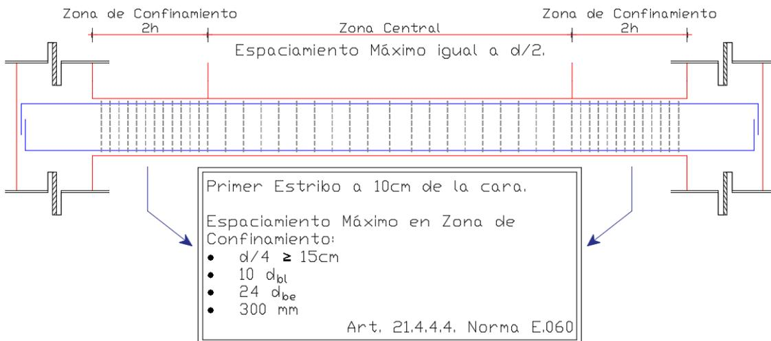
**Figura N° 138** – Esquema de espaciamiento de estribos para viga sísmica de sistema de muros – Norma Peruana.
