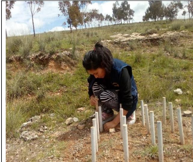
Fotografía N°3. Instalación de la parcela 1° para la medición de sedimentos- Huáchac.
