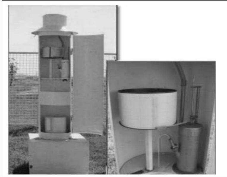
Figura 14. Pluviógrafo de Flotador.
