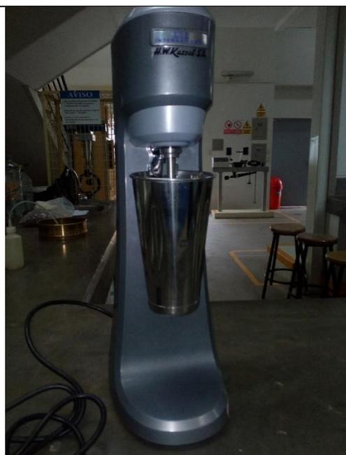
Fotografía N°29. Máquina dispersante con vaso metálico
