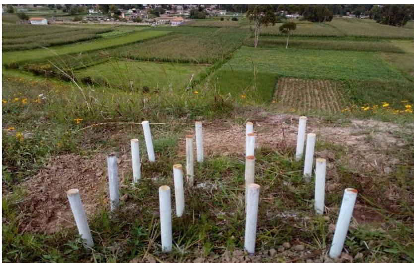
Fotografía N°6. Instalación de la 2° parcela para la medición de sedimentos-
