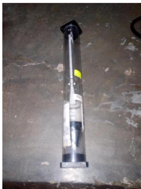
Fotografía N°30. Hidrómetro de Bouyoucos
