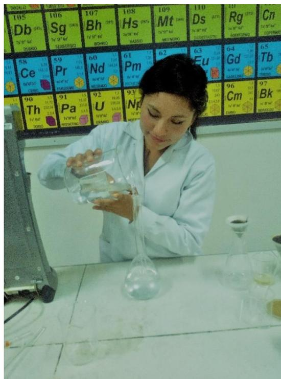
FotografíaN°40. Medición de volumen ya disuelto del reactivo (hexametáfosfato de sodio)
