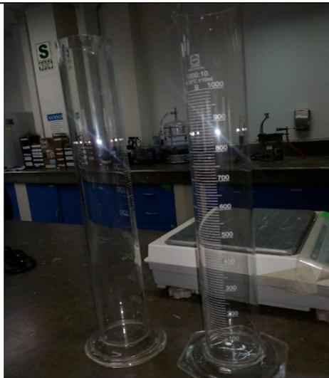
FotografíaN°37. Probeta de sedimentos (bouyoucos)
