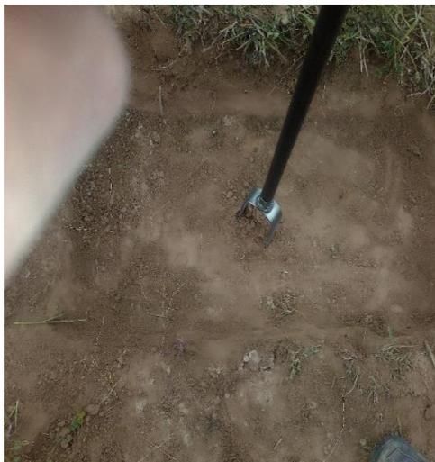
FotografíaN°22. Recolectando el suelo donde se determinó de densidad aparente del suelo con el muestrador – Huamancaca Chico
