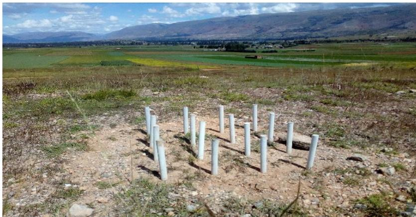
Fotografía N°5. Instalación de la 1° parcela para la medición de sedimentos- Huáchac
