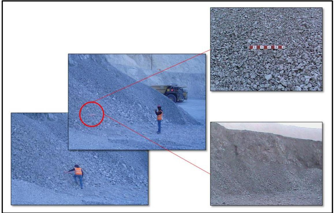
*Figura 28, Muestreo de fragmentación en mina*
