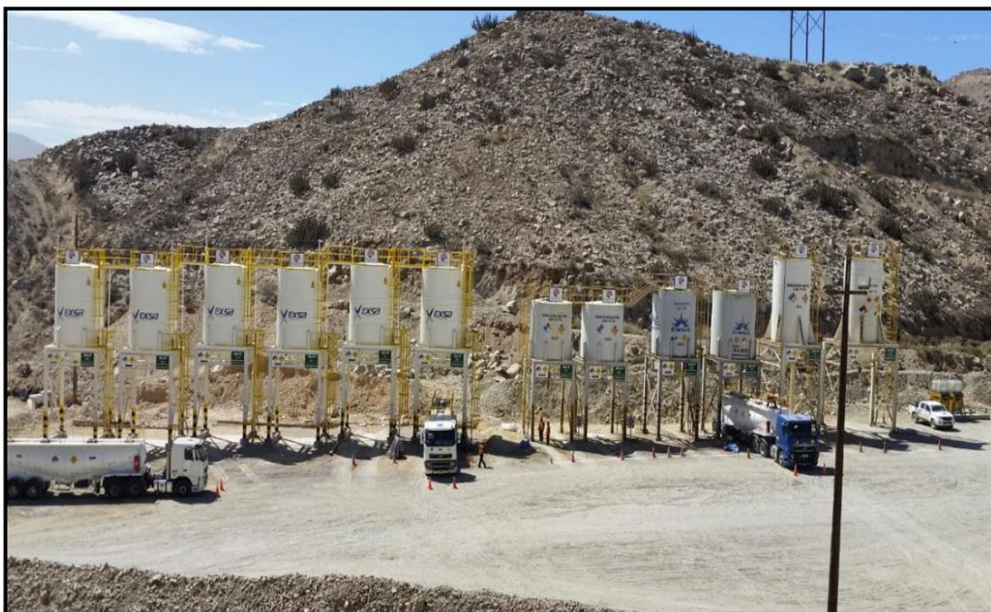
*Figura 9, Infraestructura instalada: Silos de Emulsión*
