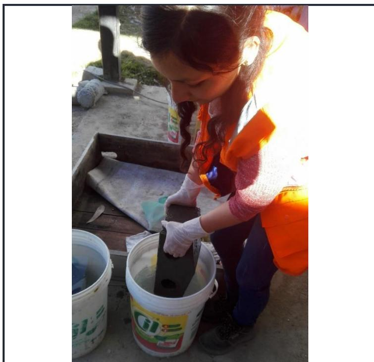
*Figura 55: Inmersión de los bloques de Concreto aligerado.
