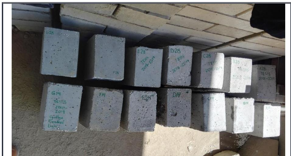
Figura 24: Secado de los Bloques de Concreto Aligerado.
