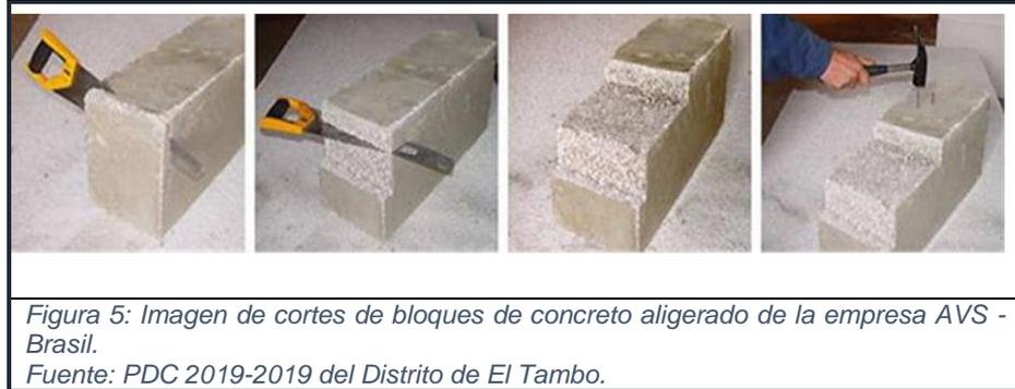
Se hace mención también que, debido a sus características, este material puede ser utilizado para diferentes tipos de trabajos, como es el caso de construcción de viviendas, pisos, para aislamientos térmicos y acústicos, paredes corta fuego, entre otros.
