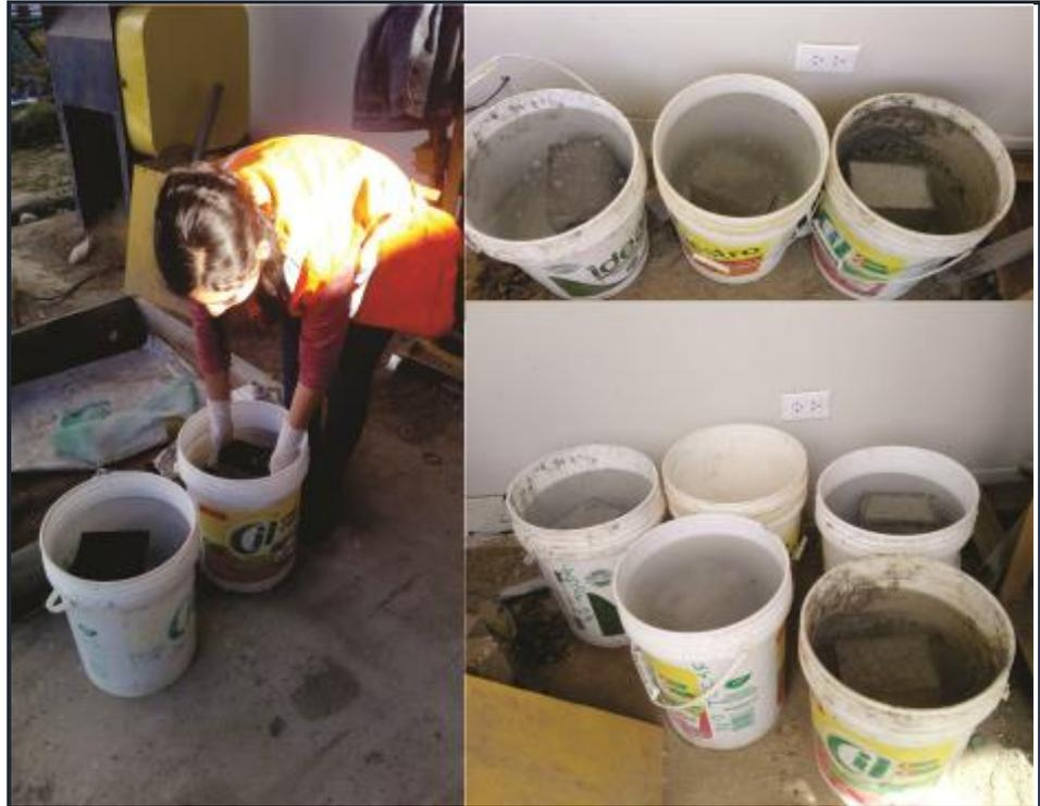
Figura 23: Curado de Bloques de Concreto Aligerado.
