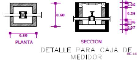
DETALLE PARA CAJA DE MEDIDOR
