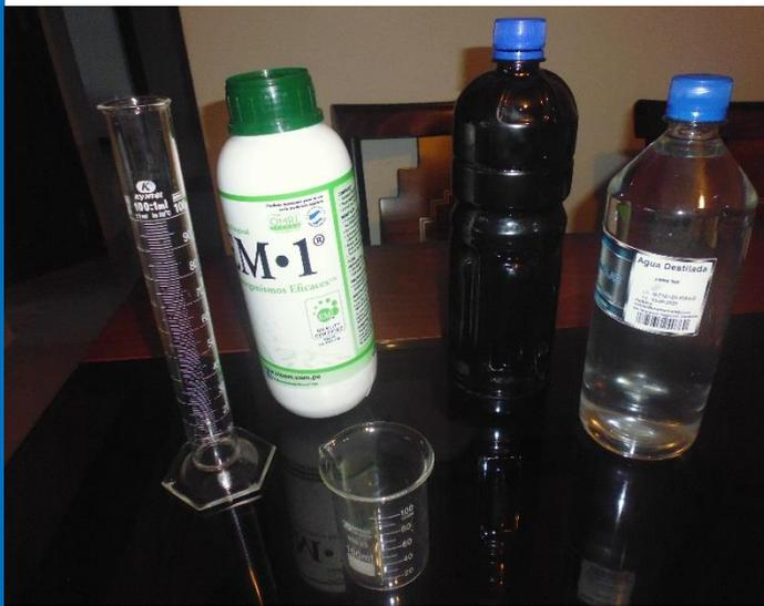
**MATERIALES UTILIZADOS: EM-1, MELAZA , AGUA DESTILADA , PROBETA Y VASO DE PRECIPITACION**
