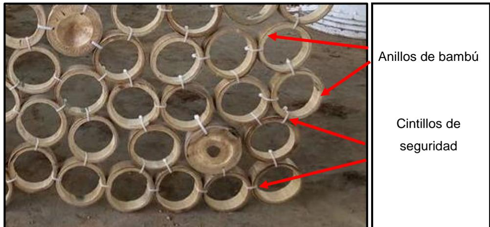
Figura 87: Unión de anillos de bambú.
