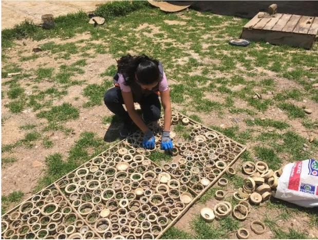
Proceso de Unión de Anillos de Bambú con cintillos de seguridad
