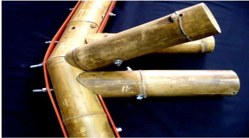
Figura 39: Uniones a corte sesgo de boca de pescado (Pletinas, pernos simples, tensores y tuercas de acero).
