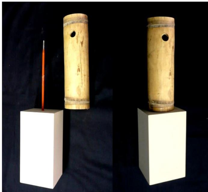
Figura 44: Unión a cimientos de concreto (Con varilla de acero empotrada e inyección de mortero de arena-cemento).
