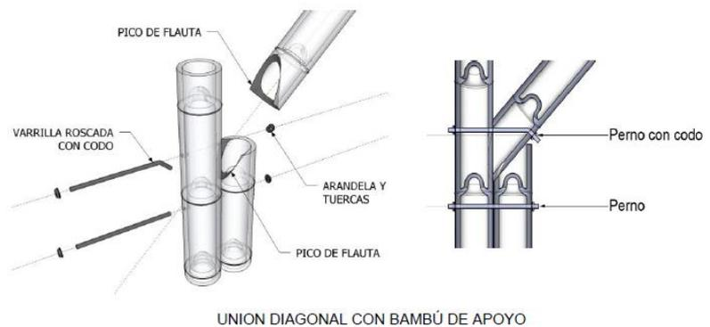
Figura 34: Unión diagonal con bambú de apoyo.
