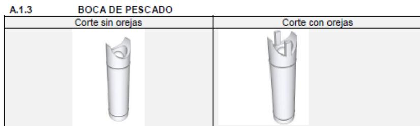
Figura 15: Tipos de cortes de piezas de bambú (Corte boca de pescado).
