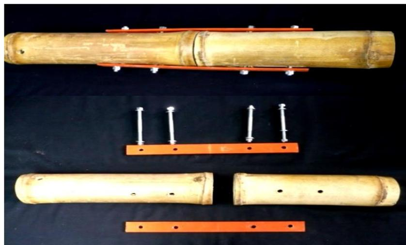
Figura 38: Unión para prolongación longitudinal (2 pletinas, pernos y tuercas de acero).
