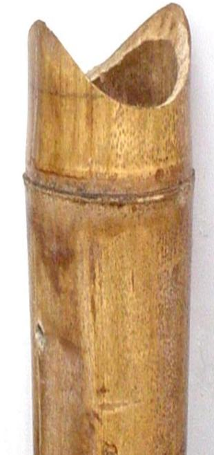
Figura 17: Corte boca de pez (Principio Universal)
