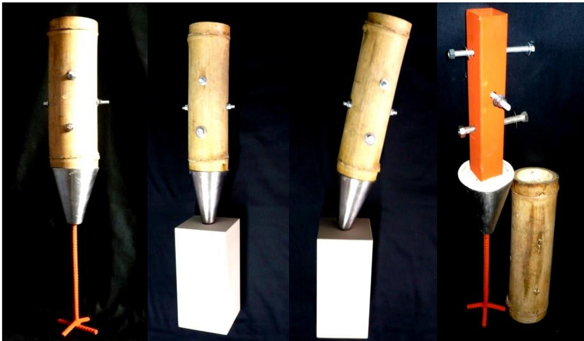
Figura 46: Unión a cimientos de concreto (Cono de acero inoxidable).
