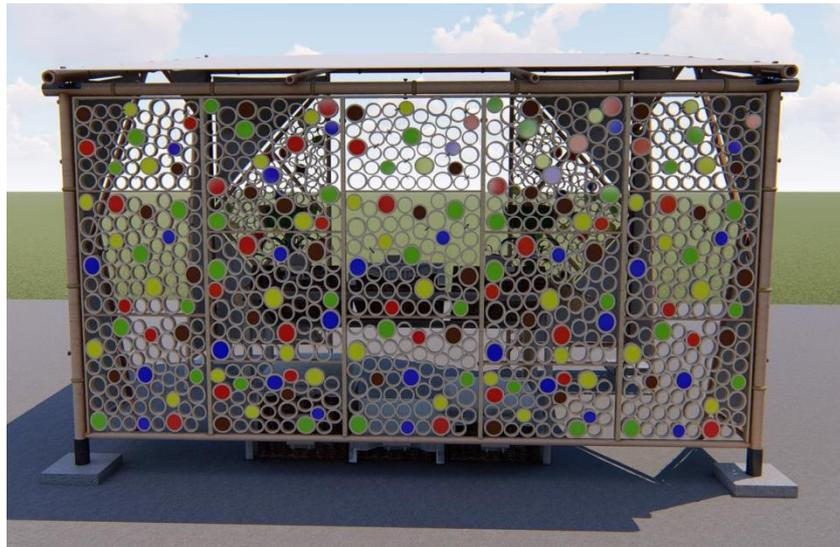
Figura 89: Paneles de anillos de bambú- Parte Posterior.
