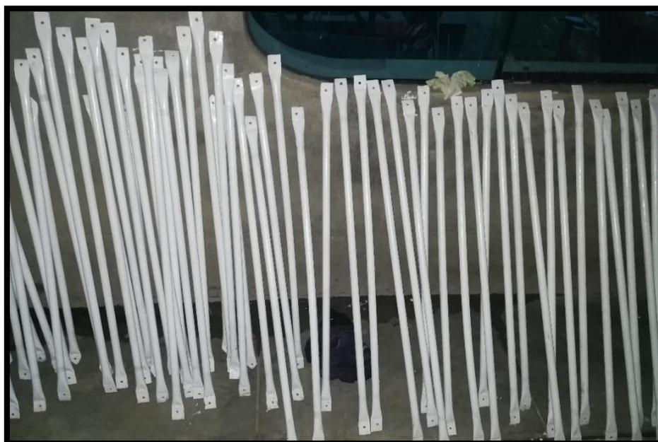
Fotografía 6: Secado de Varillas
