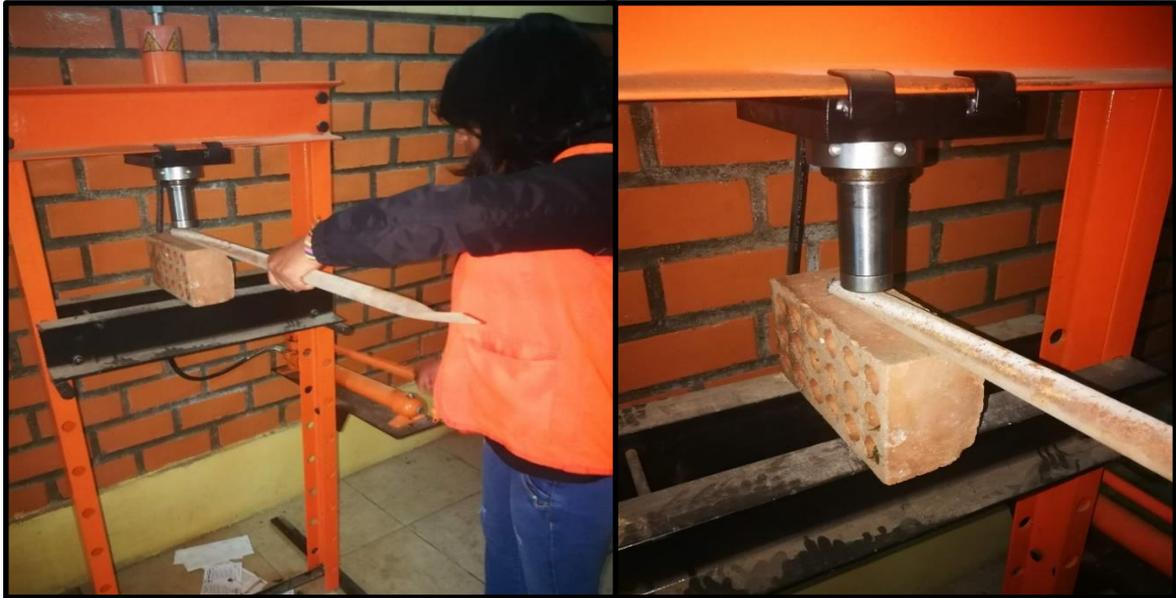
Fotografía 3: Prensado de esquina de varillas
