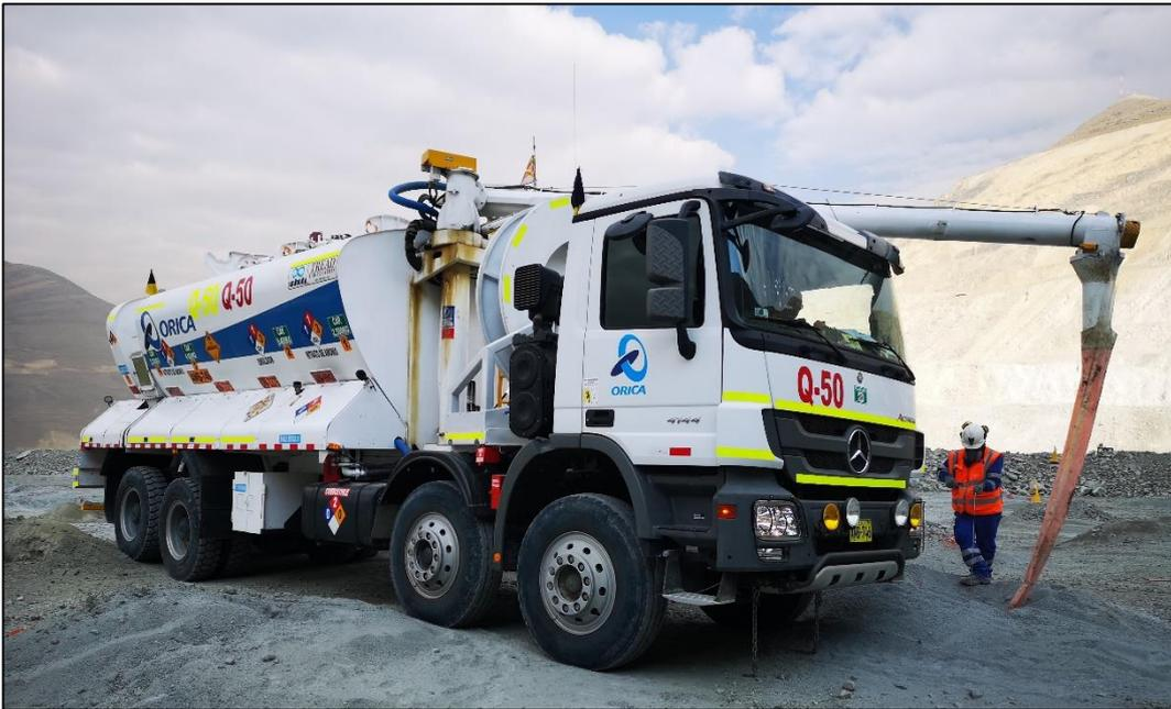
Figura anexo 3: Camión fabrica Orica™ - MMU
