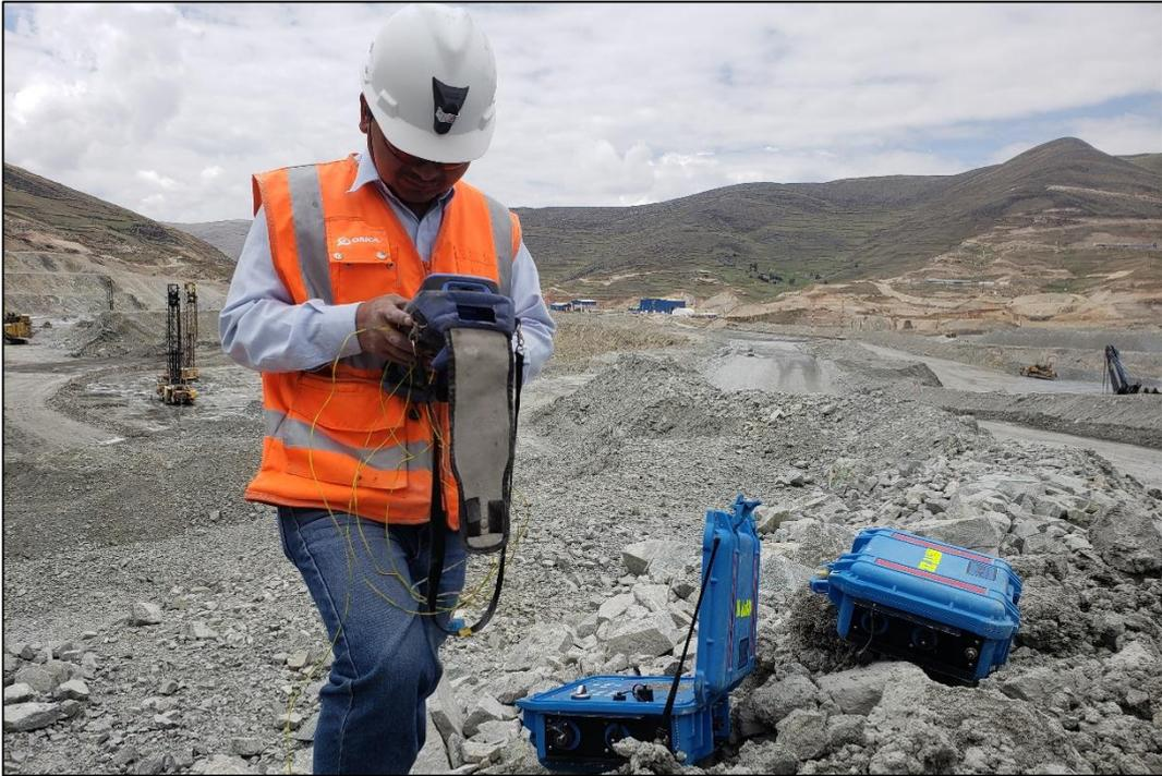
Figura anexo 5: Programación de detonadores I-kon™ III
