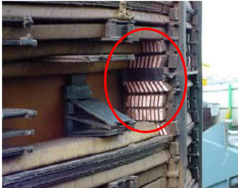
*Figura 41.* Bobina inclinada fase A (fase R)
