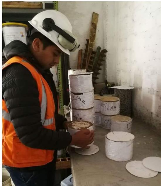
**Figura 25.** Etiquetado de muestras tratadas con Cemento, cal y emulsión
