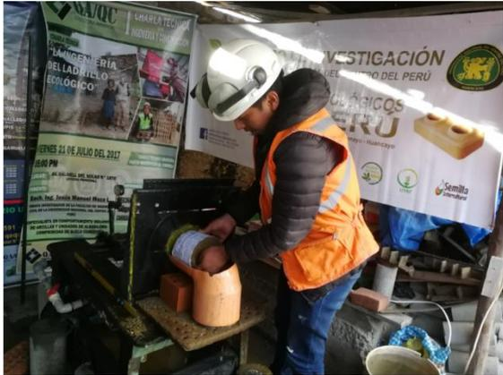
Colocación del molde de CBR para ser evaluada a través del Ensayo de Geelong Modificado.
