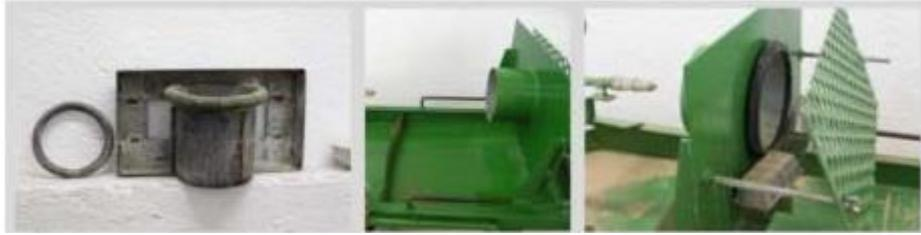
**Figura 12.** Sistema de Colocación para muestras - Ensayo por pulverizado
