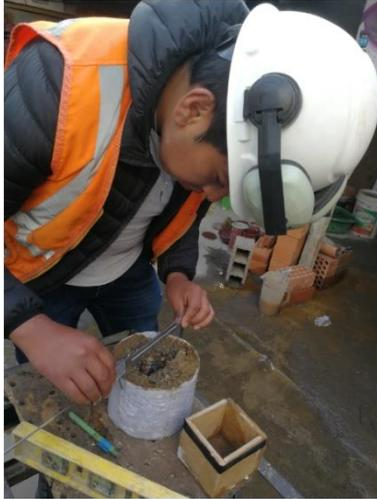
Medición del diámetro del hueco ocasionado por el chorro de agua.
