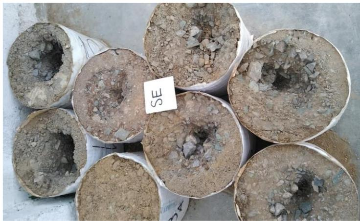
**Figura 31.** Muestras después del ensayo de Geelong
