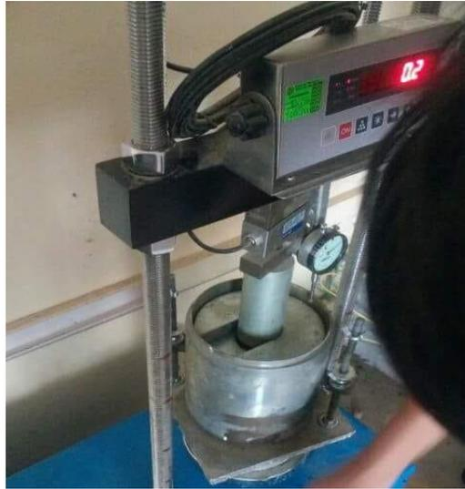
**Figura 21.** Cálculo de Penetración y Dial
