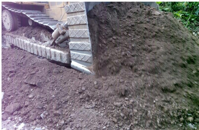
**Figura 13.** Obtención de agregado granular y fino – Cantera Km 80
