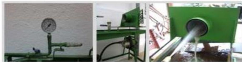
**Figura 9.** Sistema de Presión - Ensayo de Pulverizado
