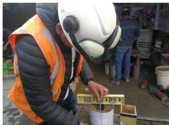
Nivelación con nivel de mano y posterior medición de la profundidad de daño ocasionado por el chorro de agua.
