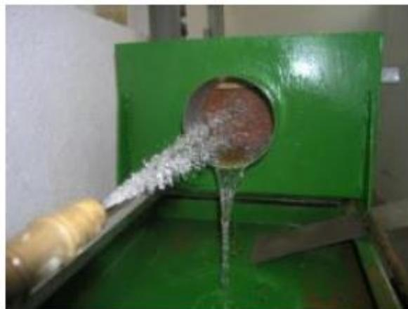
**Figura 10.** Aplicación del Ensayo de erosión por pulverizado
