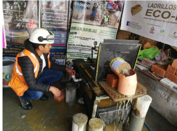
Apertura de la Llave de Paso para iniciar el proceso de ensayo a una presión de 50 Kips.
