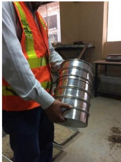
**Figura 16.** Tamizado del material seleccionado como muestra
