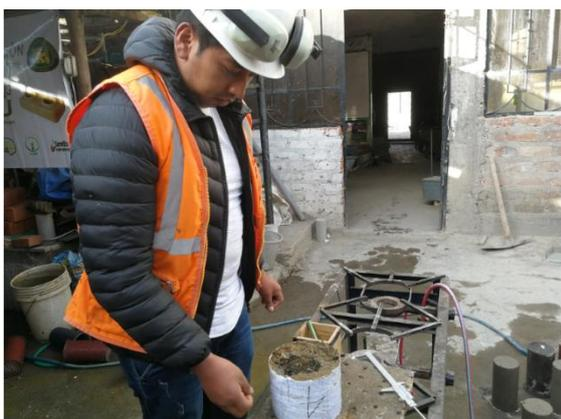
Colocación del molde ensayado en una superficie plana para tomar las mediciones correspondientes.
