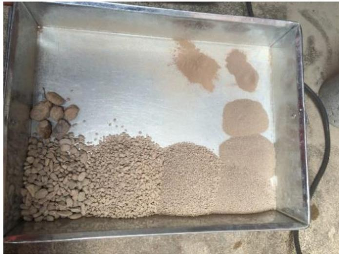
**Figura 17.** Pesado del material retenido según cada tamiz
