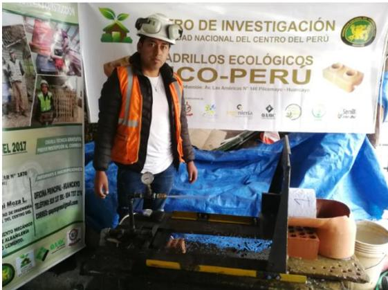
Ensayo de Geelong Modificado en ejecución por el lapso de 15 minutos.
