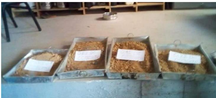
*Figura 19.* Proporciones de mezcla para CBR (Fino- Grueso)
