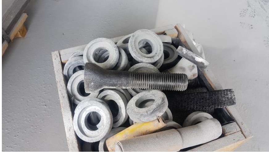
Figura 37. Tuercas, arandelas, gomas de arandelas y botado de pernos
