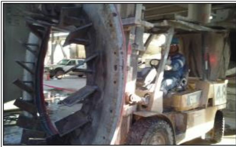
Figura 16. Retiro de Sello Sandwich Utilizando Montacargas
