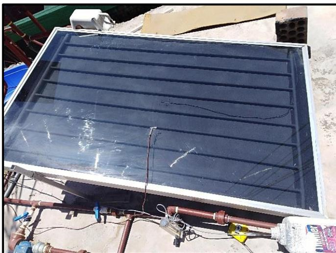
*Figura 39.* Foto de colector solar normal.
