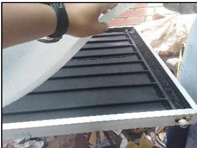
*Figura 40.* Foto de adaptación de placa aislante tipo colmena de abeja con configuración vertical.
