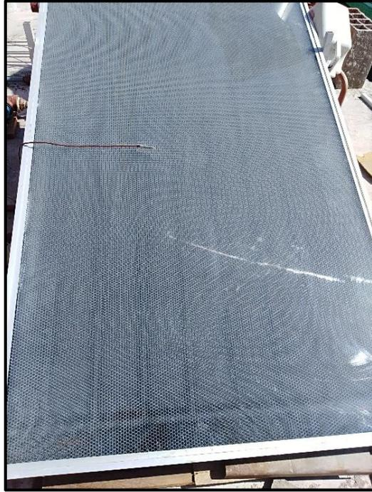
**Figura 41.** Foto de adaptación de placa aislante tipo colmena de abeja con configuración horizontal al colector solar.
