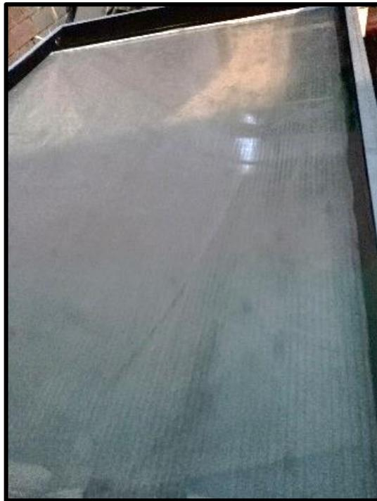
**Figura 42.** Foto de colector solar con placa aislante tipo colmena de abeja con configuración vertical adaptado.
