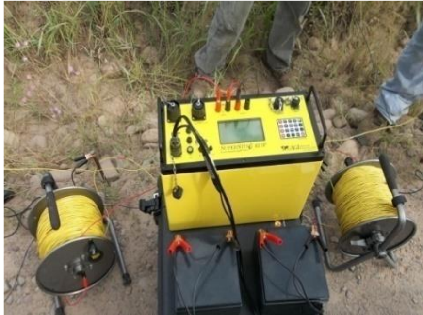
Figura 4. Medidor de resistividad Super Sting R1 IP.
