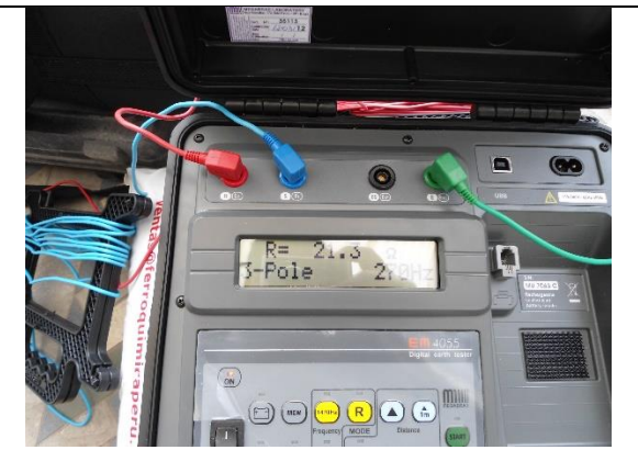
Fotografía 2. Medición en terreno tipo cascajo.
