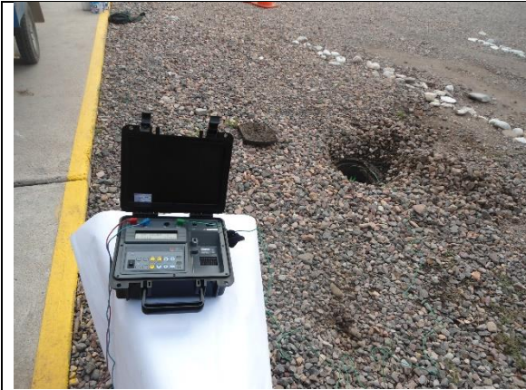
Fotografía 1. Medición en terreno tipo cascajo.
