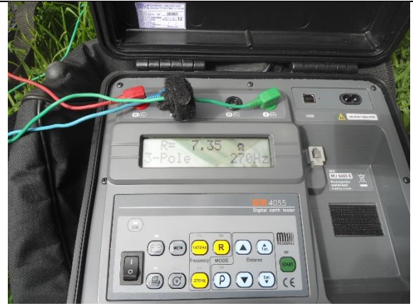
Fotografía 2. Medición en terreno tipo arcilloso.
