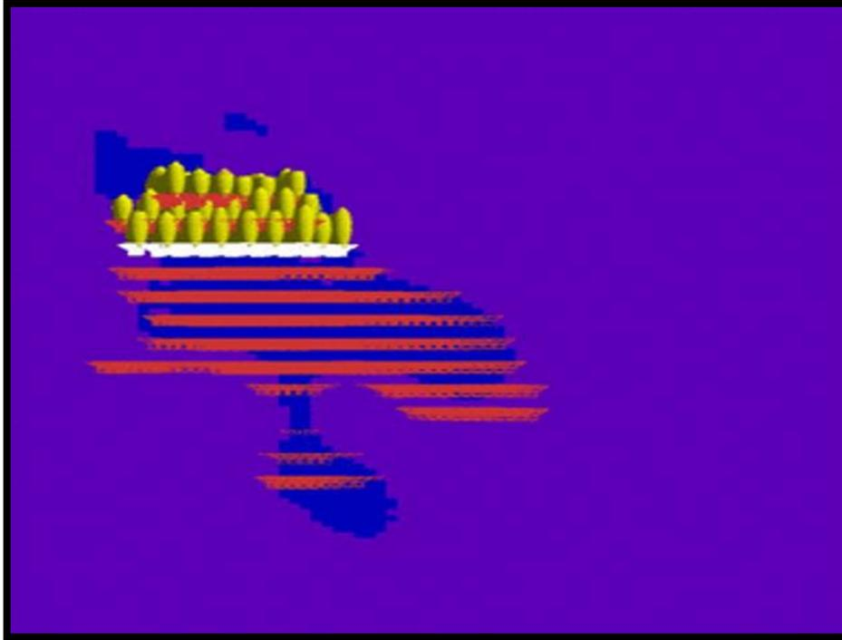
Figura 38: Evolución elipsoides de extracción. espaciamento 5.5m
