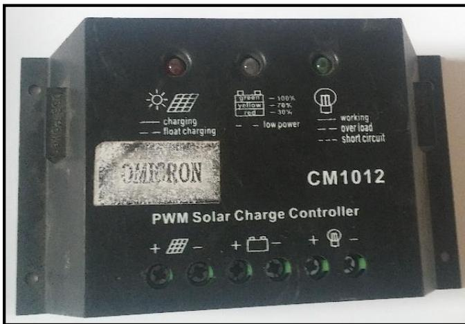
Figura 12. Regulador de voltaje para panel solar de 12 voltios.
