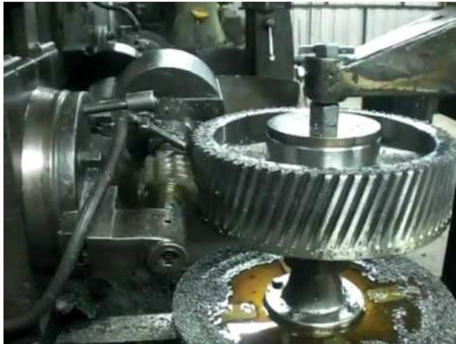
Fig. 16 Fabricación de Engranaje
