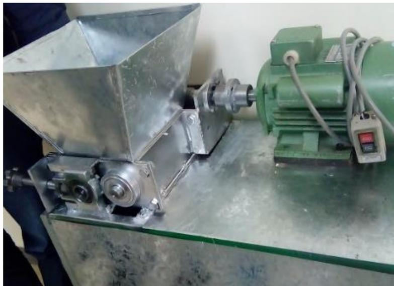
Fig. 15 Acoplamiento de Motor y Eje
