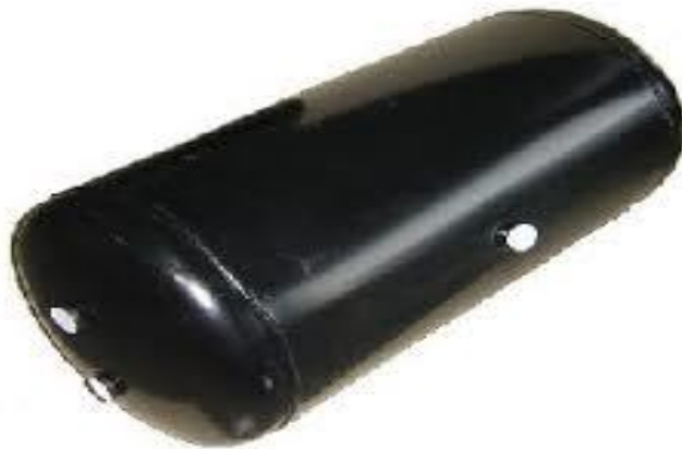
Ilustración 18: Depósitos de aire
