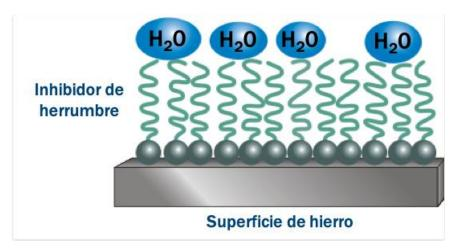
Figura 7 Cómo trabajan los inhibidores de corrosión Fuente: http://tribologiauteq.blogspot.com/2013/08/
