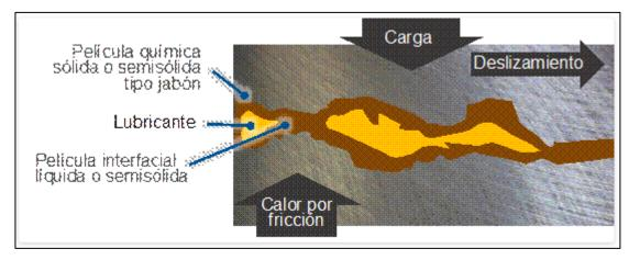
Figura 8 Cómo funcionan los aditivos antidesgaste y extrema presión Fuente: http://noria.mx/
