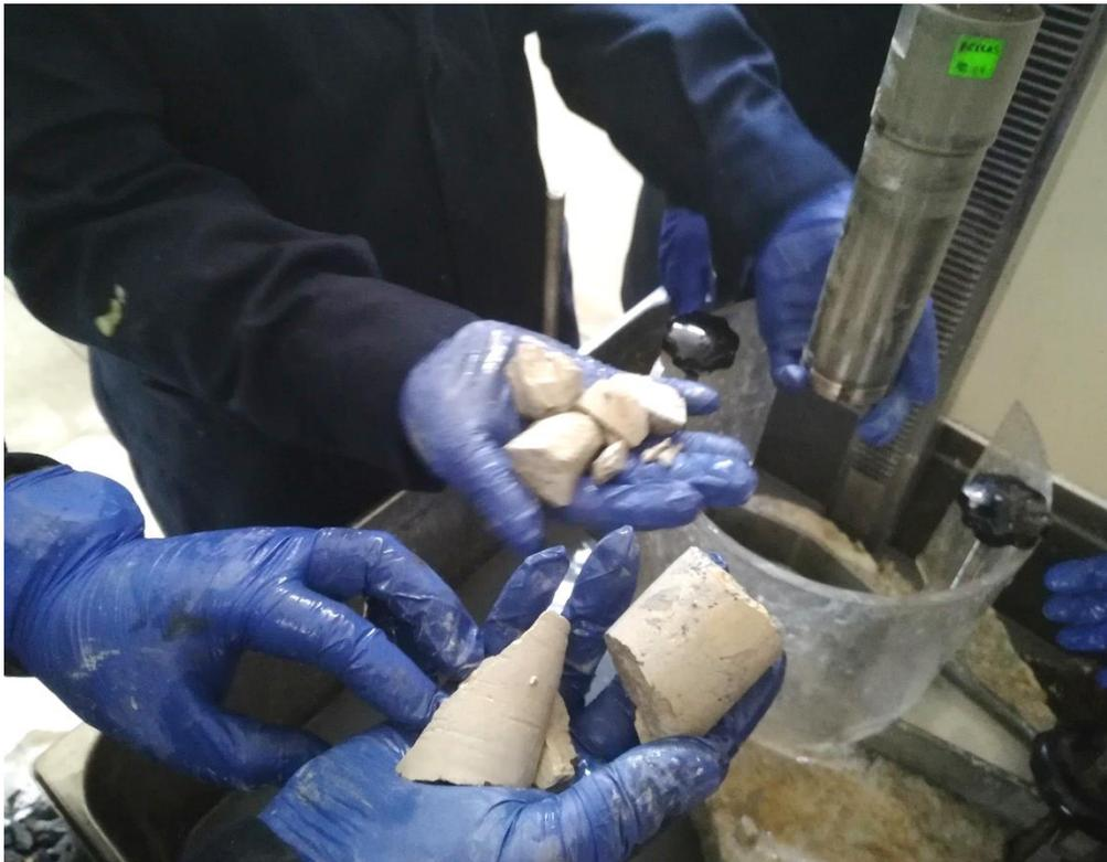
**Figura N° 14: Pizarras bien fracturadas en pruebas de carga puntual, Nivel 1 U.M. Fénix.**
