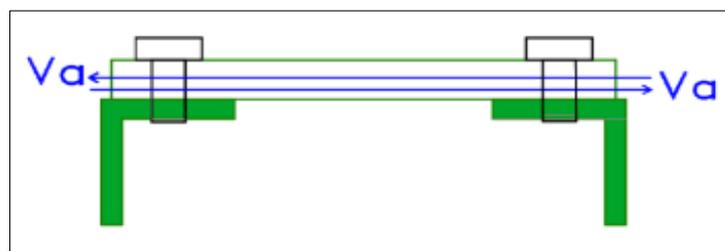
Figura 161. Cortante en la plancha de unión-eje longitudinal.
