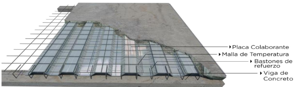
*Figura 39.* Sistema de placa colaborante apoyado en vigas de concreto. Tomado de “Manual técnico para el uso de placas colaborantes para losas de entepiso”, por Acero Deck. Lima, 2009.
