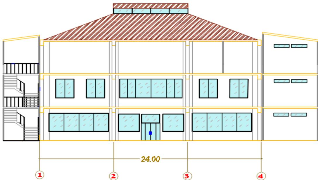
Figura 79. Arquitectura-elevación frontal segunda alternativa-techado a cuatro aguas
