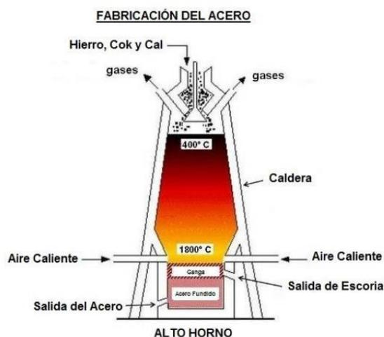
Figura 2. Fundición en alto horno. Tomado de Área tecnológica, 2014. Recuperado el 7 de octubre de 2018. <http://www.areatecnologia.com>.
