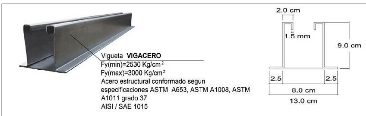
Figura 68. Vigueta de acero galvanizado. Tomado de “Manual de instalación de techo aligerado con viguetas prefabricadas de acero”, por SENCICO, Lima, Cartolan Editores, 2014.
