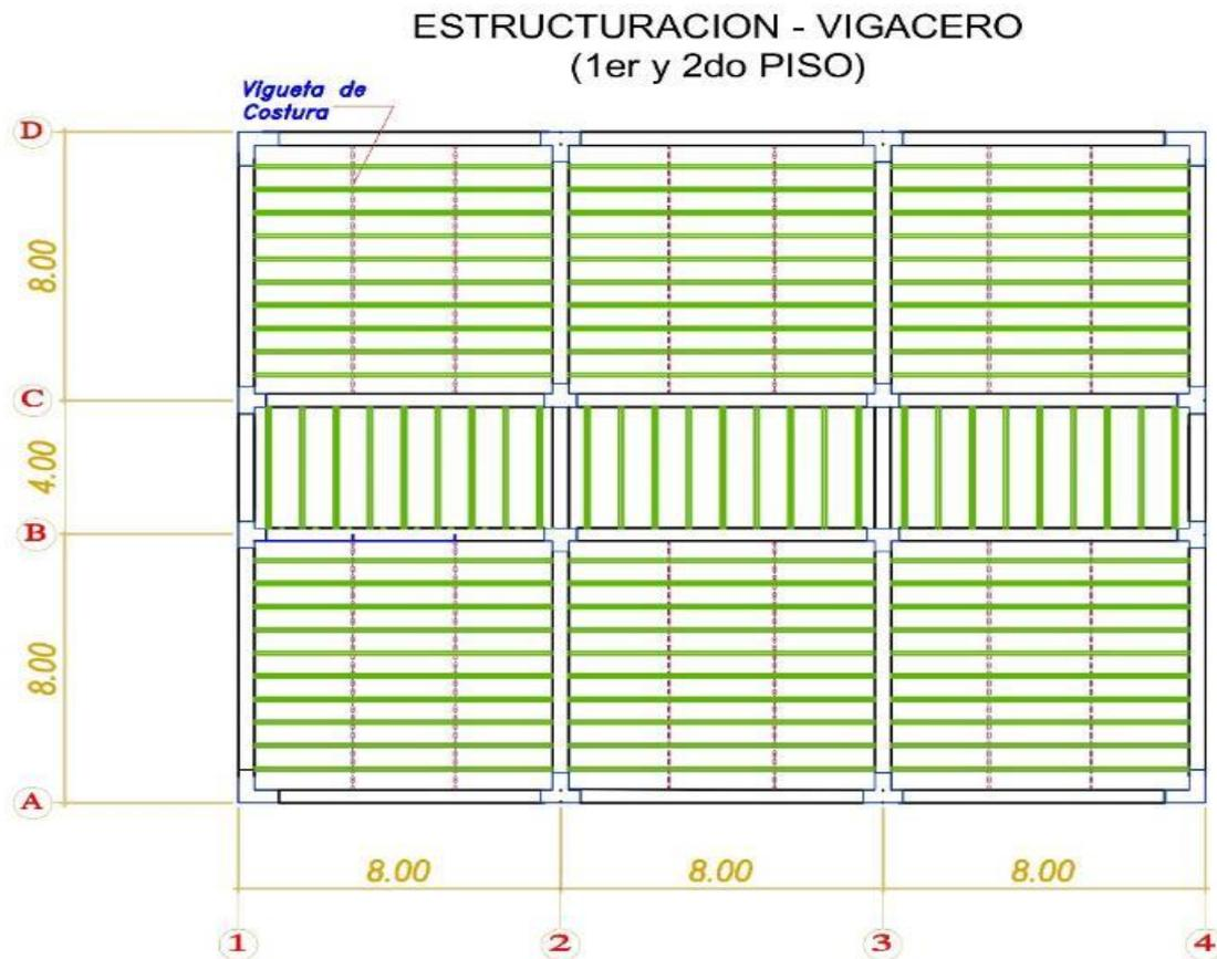
Figura 88. Dirección de las losas en el sistema Vigacero
