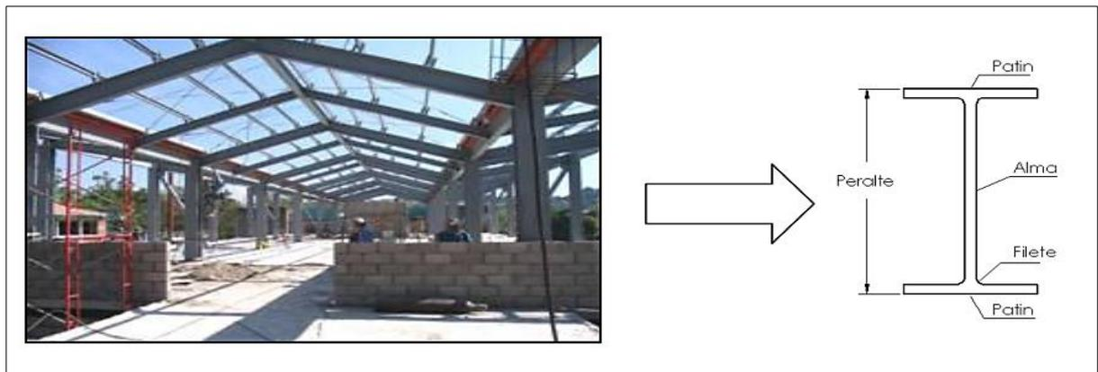
*Figura 25.* Viga de alma llena de sección constante tipo I. Tomado de “Estructuración, análisis y diseño estructural de elementos de techo con perfiles metálicos utilizando el metodo LRFD”, por C. Cruz, Carlos, P. Figueroa, Paolo y C. Hernandez. Universidad de El Salvador. Ciudad Universitaria, 2012. Tesis (título).
