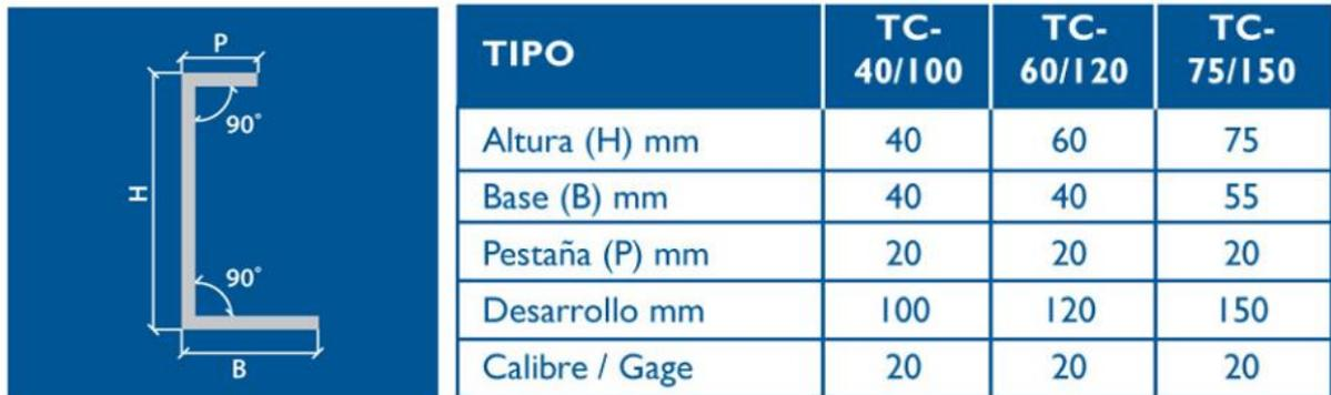
Figura 45. Tope de cierre y sus dimensiones. Tomado de “Manual técnico para el uso de placas colaborantes para losas de entrespiso”, por Acero Deck. Lima, 2009.
