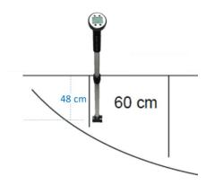
d) Una vez que se tenga las velocidades del tramo se puede calcular el flujo volumétrico o caudal de cada tramo.
