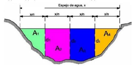
b) En cada sección se debe medir el ancho de sección y la profundidad Ejemplo: en el gráfico de abajo x=280 cm y n=50 cm
