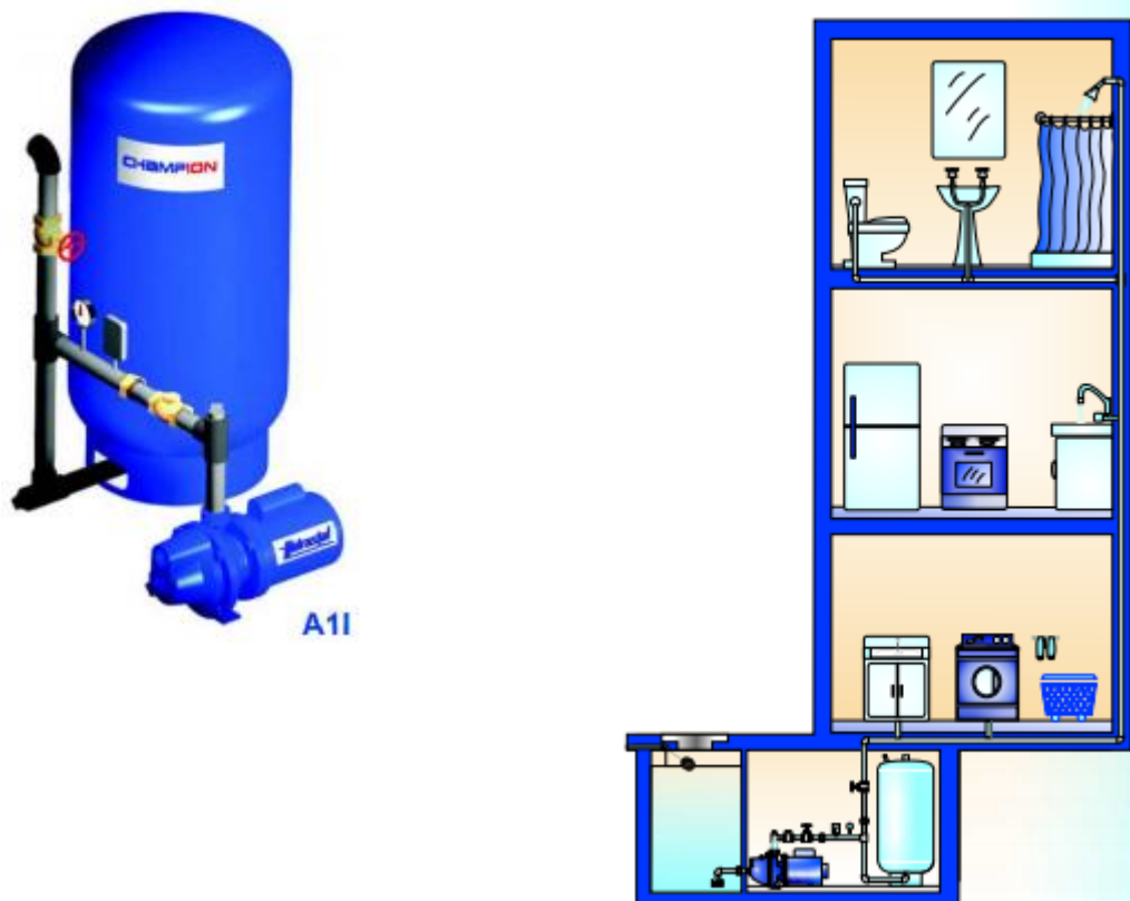
Figura 2. Equipo hidroneumático y forma de instalación - Hidrostal
