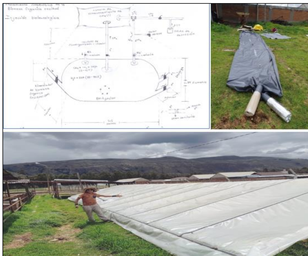
Figura 12. Diseño del Biodigester tubular
