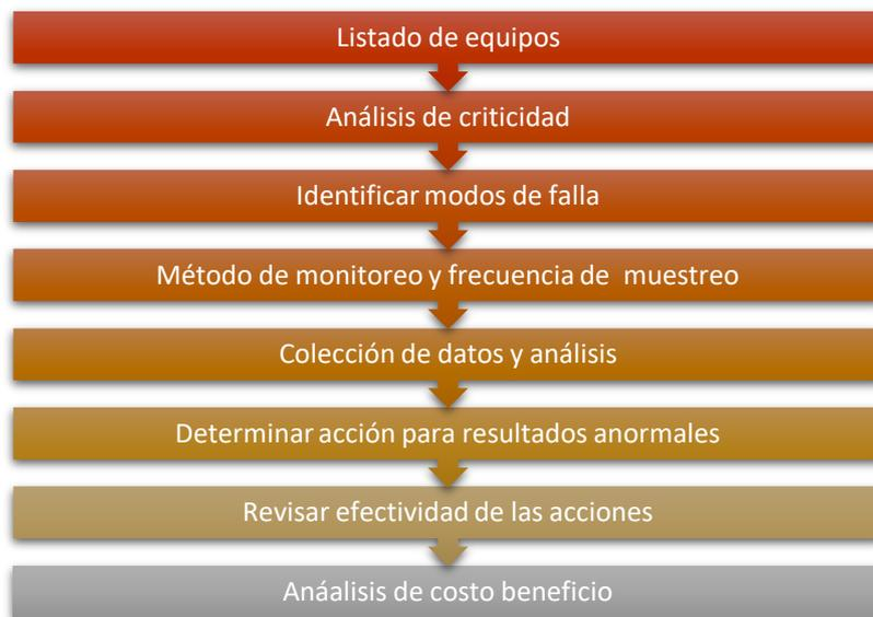
Figura N°6. ISO 17359 – Monitoreo de condición.
