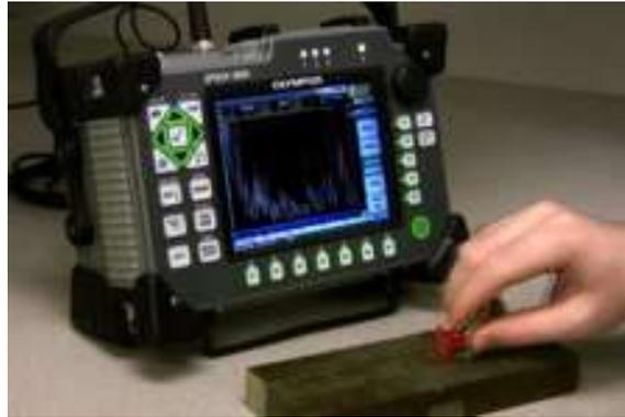
Figura N°18. Equipo de ultrasonido Epoch 1000i
