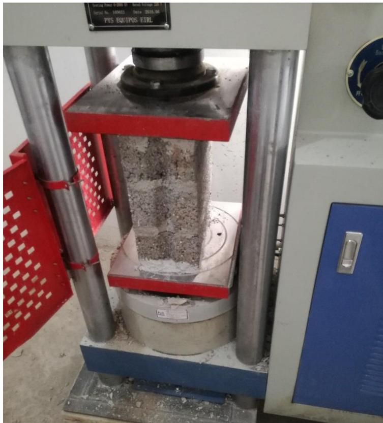
**Foto 20. Ensayo de resistencia a compresión axial en pilas con unidades de concreto**
