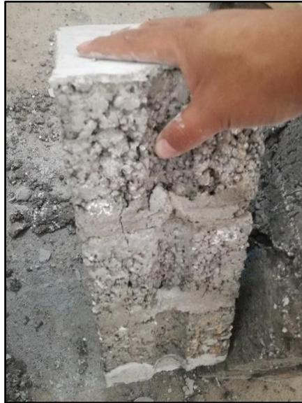
**Figura 100. Falla de Pila P2, por agrietamiento en el interior de las pilas**
