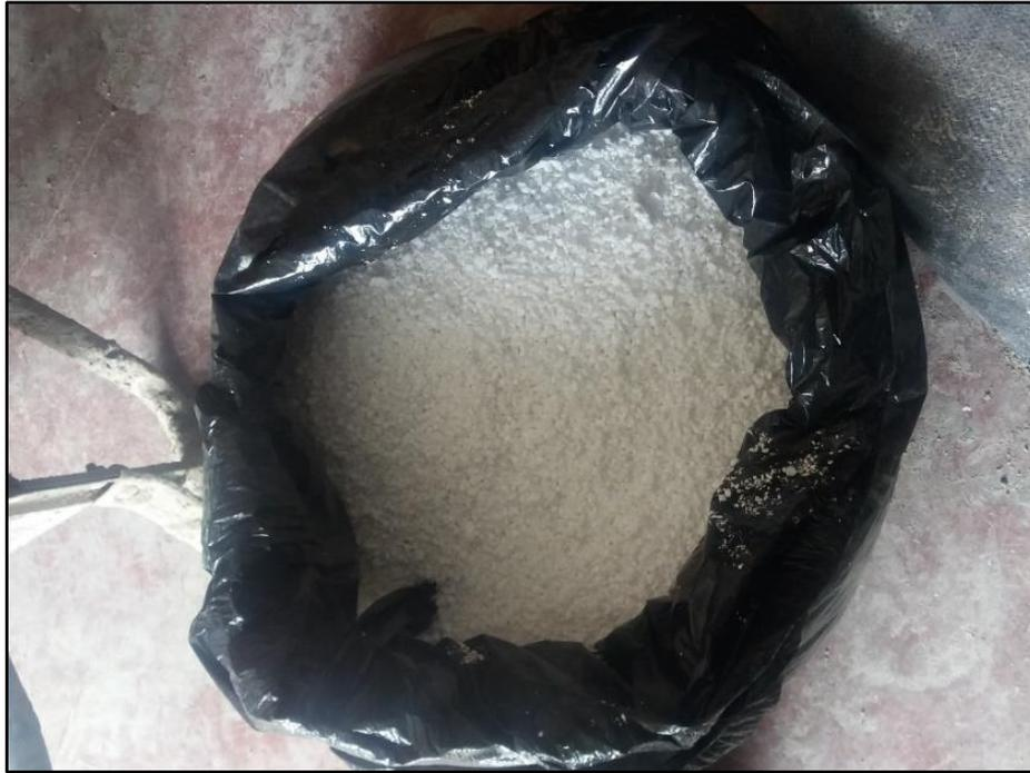
**Foto 3. Perlas de poliestireno expandido triturado de 3mm de diámetro**
