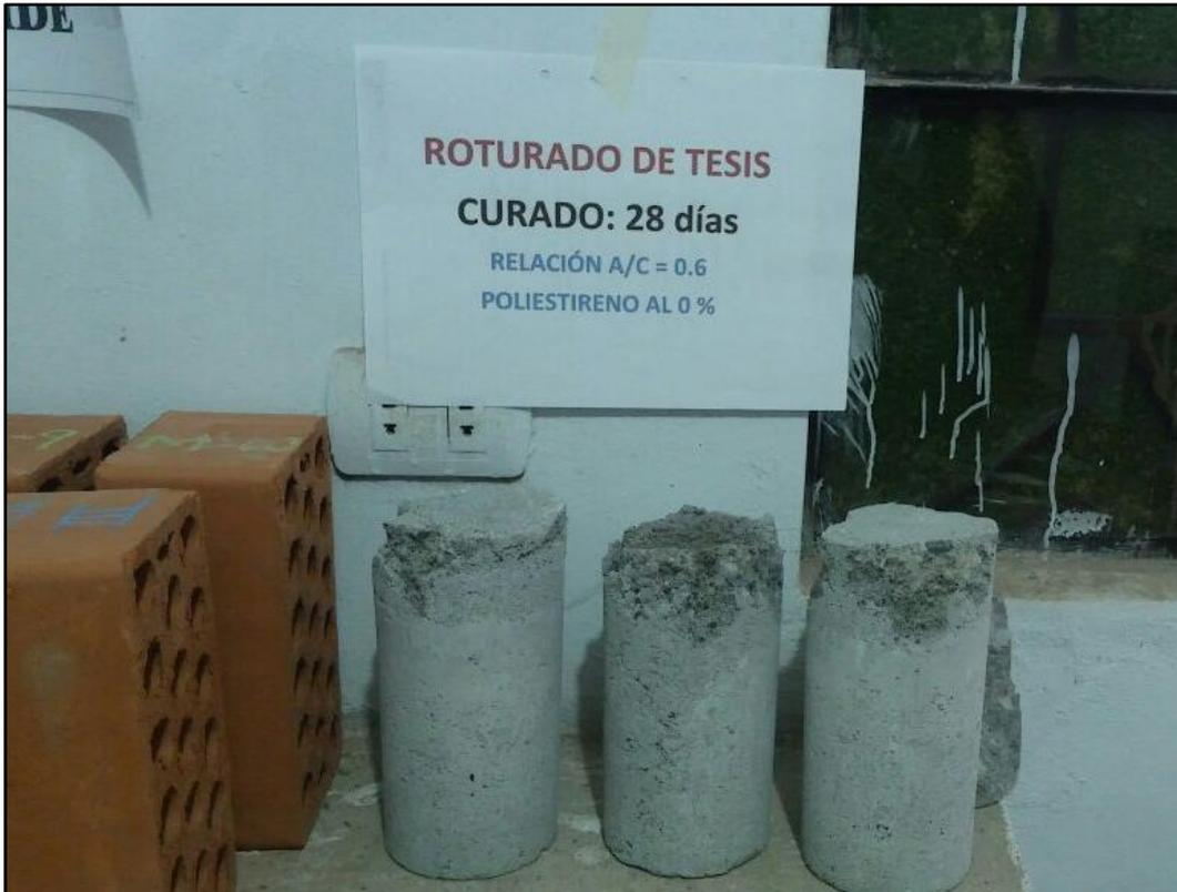
**Figura 64. Roturado de probetas de concreto a un tiempo de maduración de 28 días**
