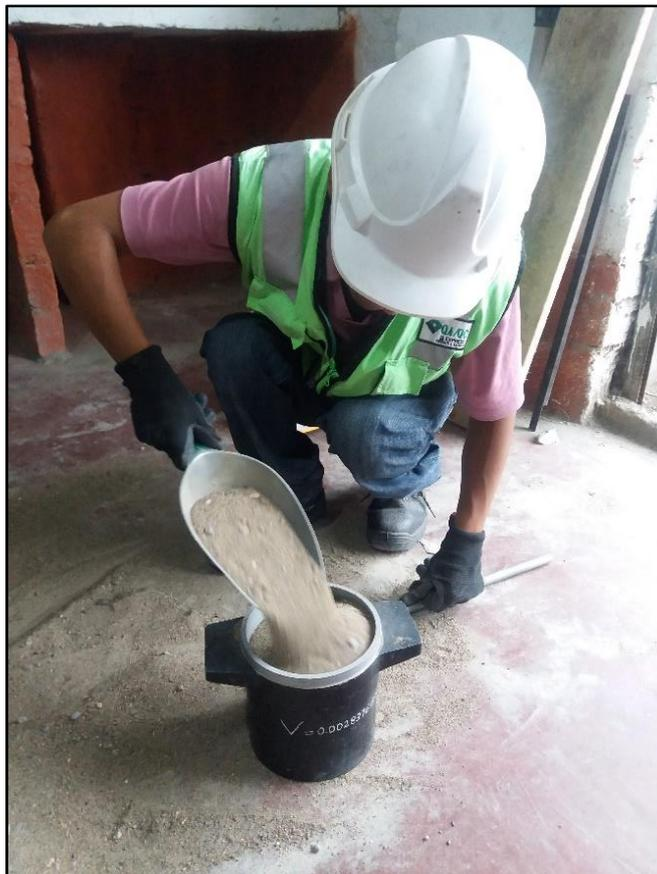
**Foto 2. Ensayo de peso unitario suelto del agregado fino**
