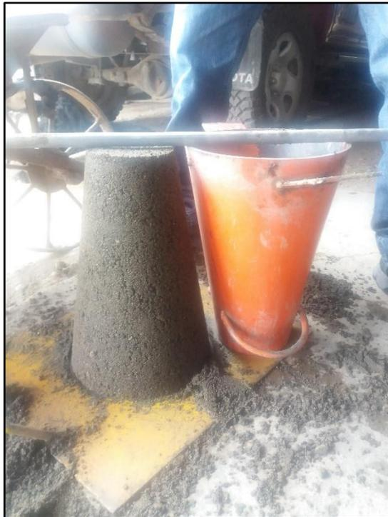
**Figura 55. Medición del Slump, con un asentamiento de 0”**
