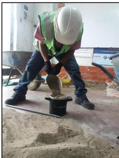
**Figura 45. Llenado de la tercera capa del ensayo de peso unitario compactado del agregado fino**
