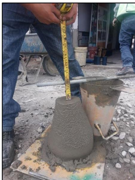
**Figura 53. Medición del slump, con un asentamiento de  $2\frac{3}{4}$ ".**
