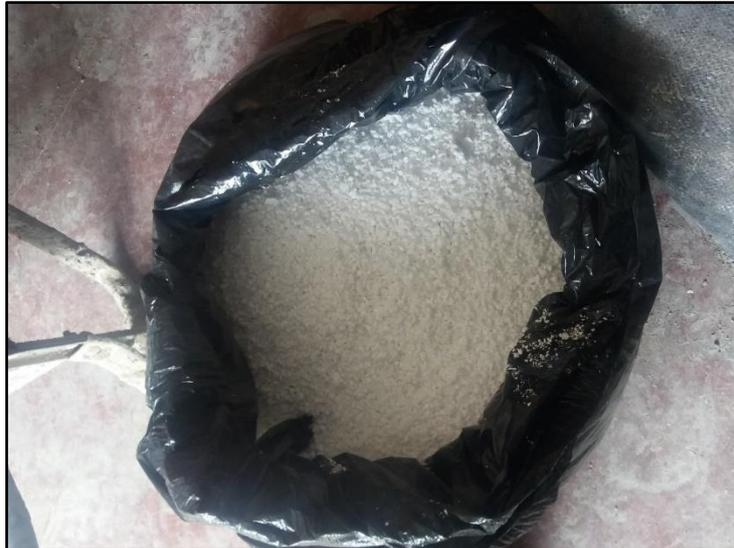
**Figura 49. Perlas de poliestireno expandido triturado de 500 gr**
