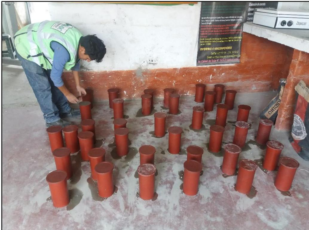
**Foto 8. Almacenaje de las probetas durante 24 horas, antes de iniciar con el curado**
