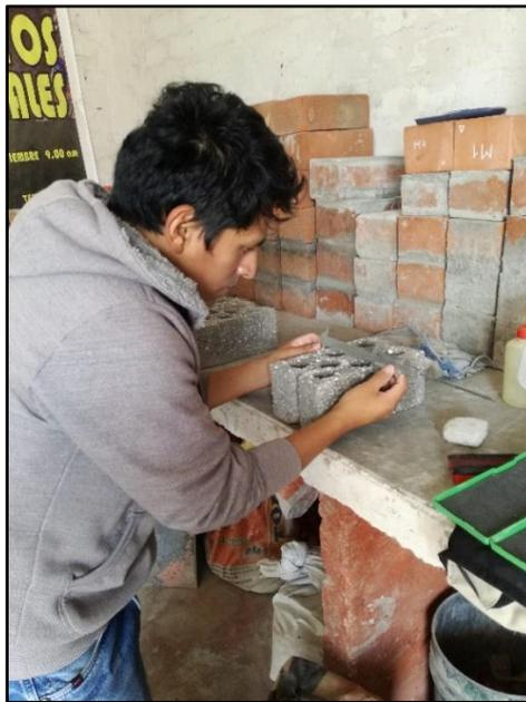
**Figura 74. Medición de los 4 lados del ladrillo**
