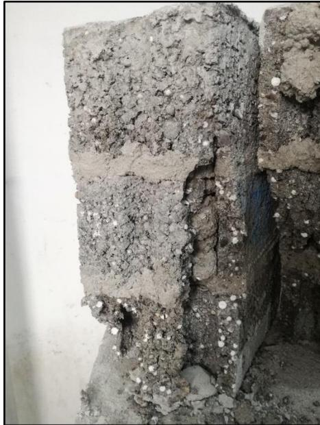
*Figura 104. Falla de Pila P6, por agrietamiento vertical y aplastamiento de unidades
