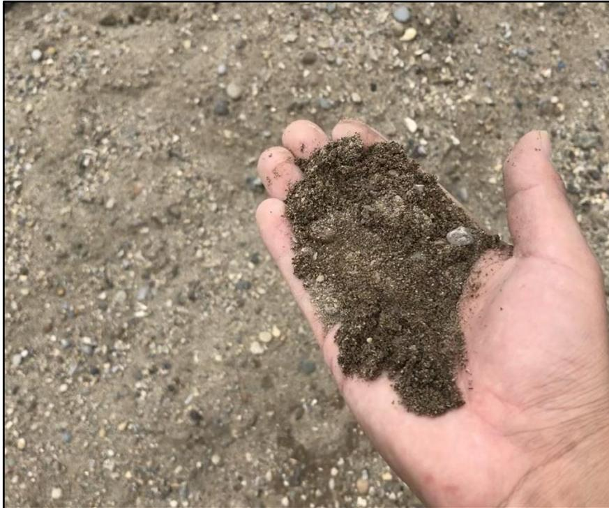
**Figura 31. Inspección del agregado fino, verificando el exceso de piedras y material orgánico**
