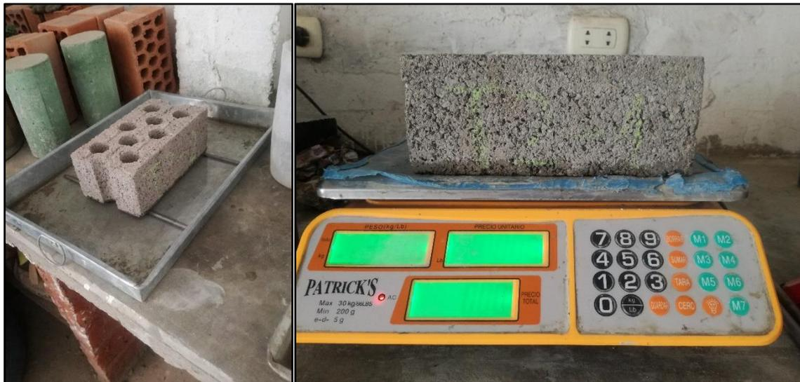
**Figura 81. Ensayo de succión de los ladrillos de concreto**
