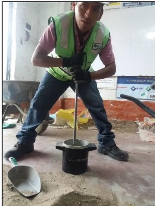
**Figura 44. Apisonado de la primera capa del agregado para el ensayo del peso unitario compactado**
