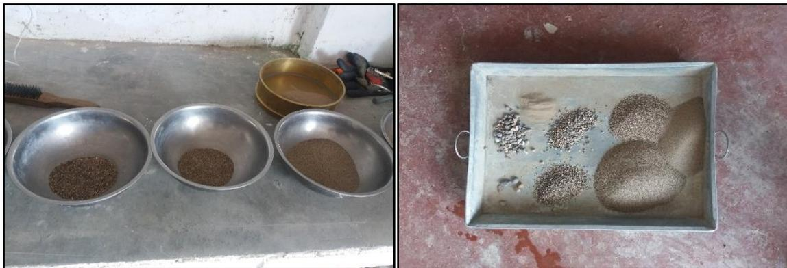
**Figura 36. Tamizado del agregado fino**
