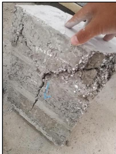
**Figura 99. Falla de Pila P1, tiene agrietamiento vertical y diagonal**
