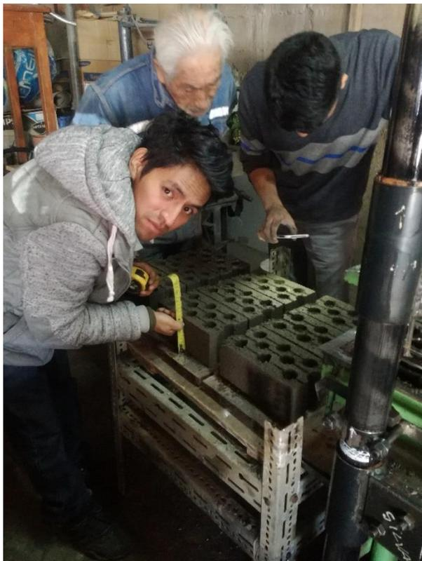
**Foto 12. Toma de medidas de las unidades de concreto recién fabricadas**
