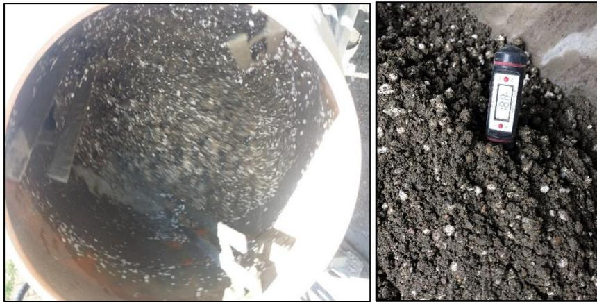
**Figura 58. Mezclado de concreto con adición de poliestireno expandido**
