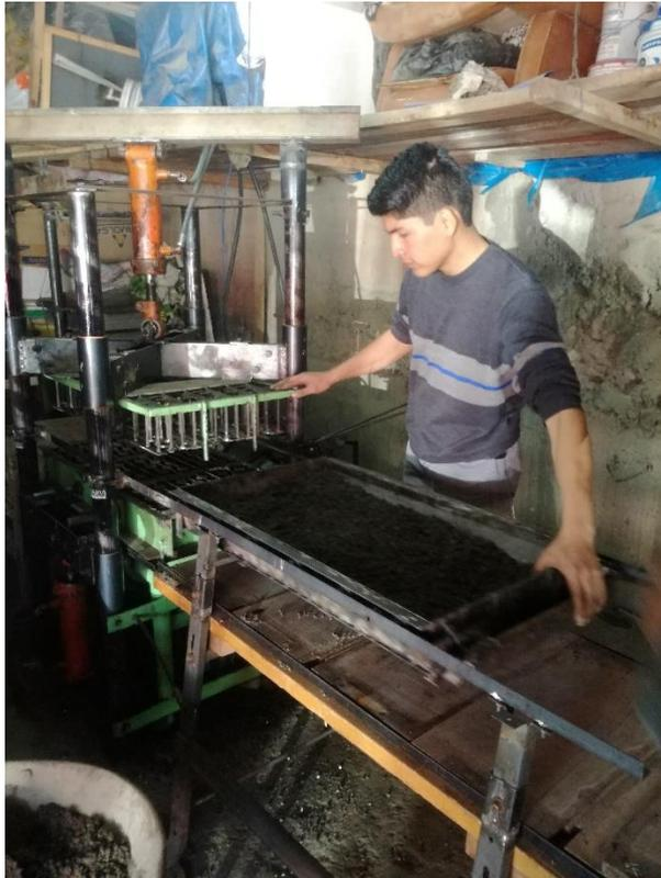
**Foto 11. Fabricación de las unidades de concreto con EPS**
