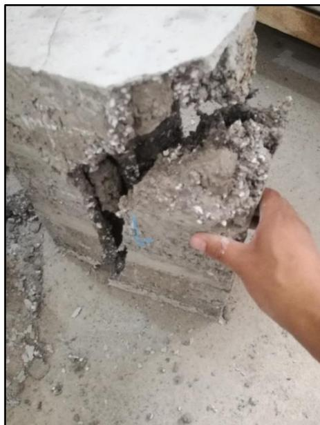
**Figura 101. Falla de Pila P3, por agrietamiento vertical con trituración de las unidades**
