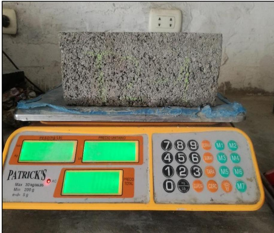
Foto 17. Ensayo de succión
