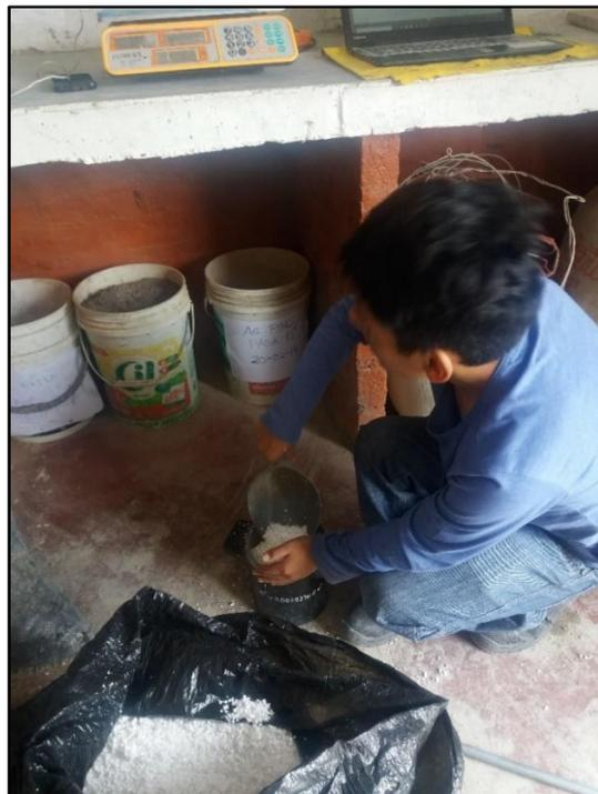
*Figura 50: Procedimiento para hallar el peso unitario suelto del poliestireno extendido.
