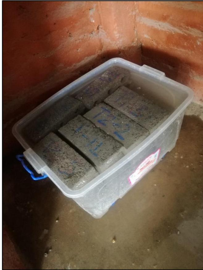
**Figura 82. Unidades de concreto completamente sumergidos en agua destilada**
