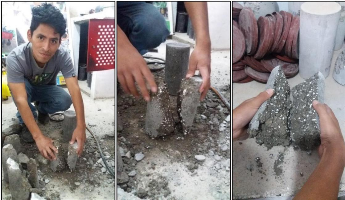
**Figura 63. Probetas sometidas a resistencia de compresión axial**
