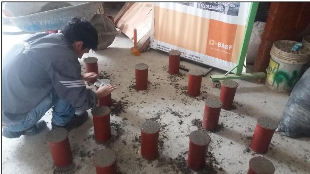
**Figura 60. Preparación de probetas de concreto**
