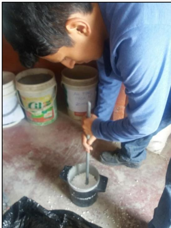
**Figura 51. Apisonado del poliestireno expandido para obtener su peso unitario compactado**
