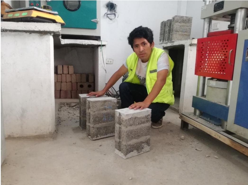
**Foto 19. Pilas con unidades de concreto antes ser roturados**
