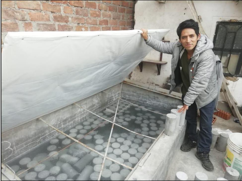
**Foto 9. Curado de las probetas de concreto dentro de pozas de agua con cal**
