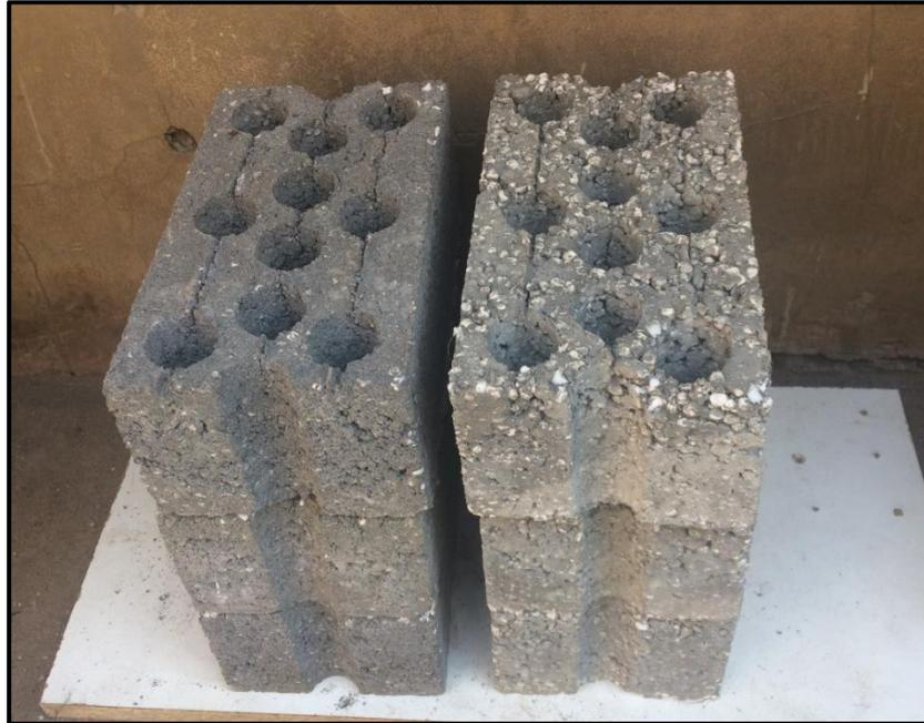
**Figura 5. Unidades de concreto ecológicos fabricados con poliestireno expandido a modo de prueba**
