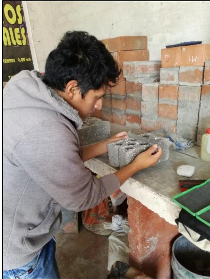
**Foto 13. Ensayo de variabilidad dimensional de la unidad de concreto**
