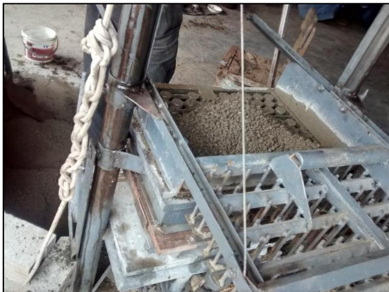
**Figura 19. Máquina tipo Semiindustrial para fabricación de ladrillos de concreto**
