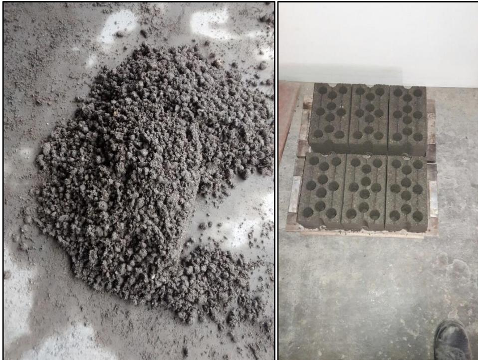
*Figura 17. Materiales utilizados en la fabricación de unidades de concreto
