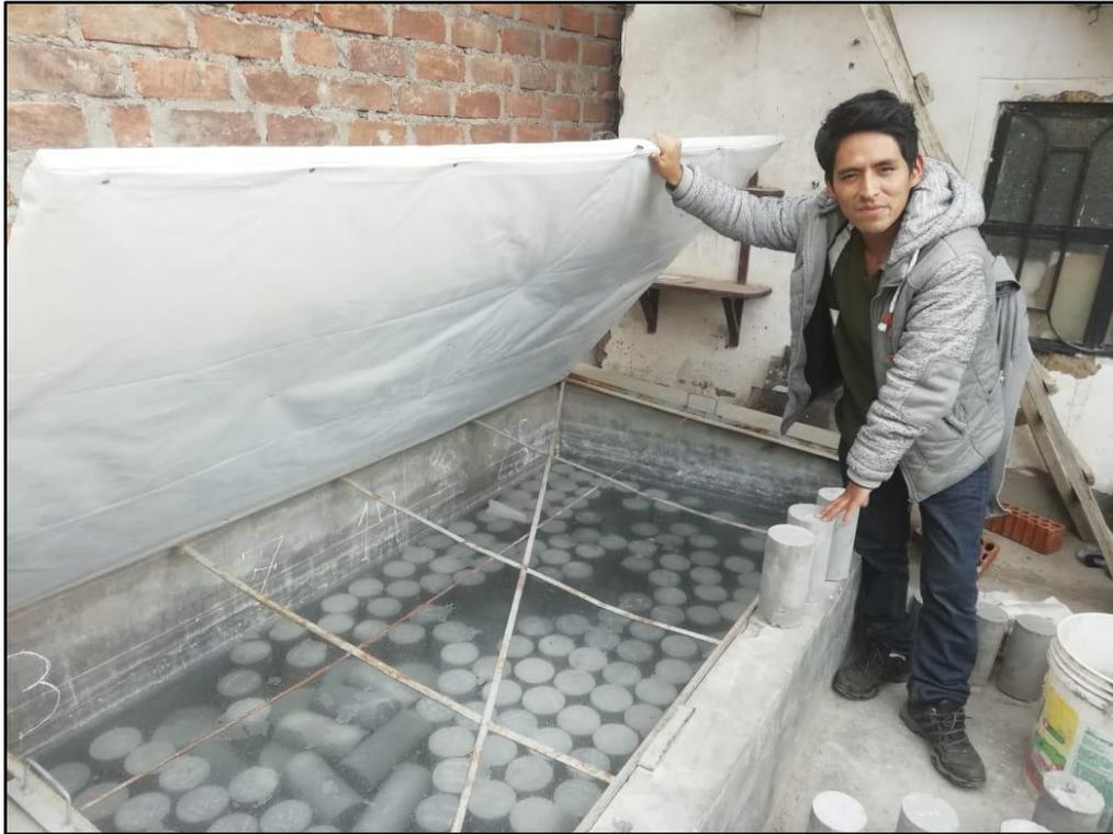
**Figura 62. Curado de las probetas de concreto dentro de pozas de agua con cal**
