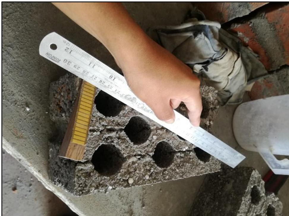
**Foto 14. Ensayo de alabeo de la unidad de concreto**
