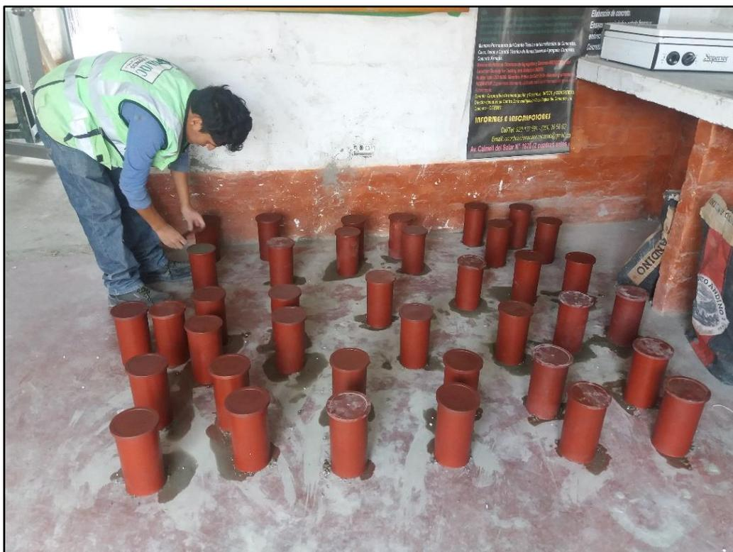
**Figura 61. Almacenaje de las probetas durante 24 horas antes de iniciar con el curado**
