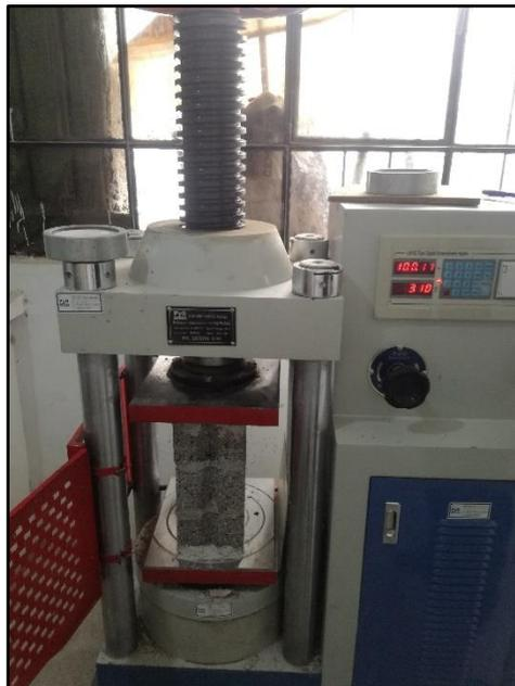
**Figura 91. Rotura de las pilas de ladrillos de concreto**
