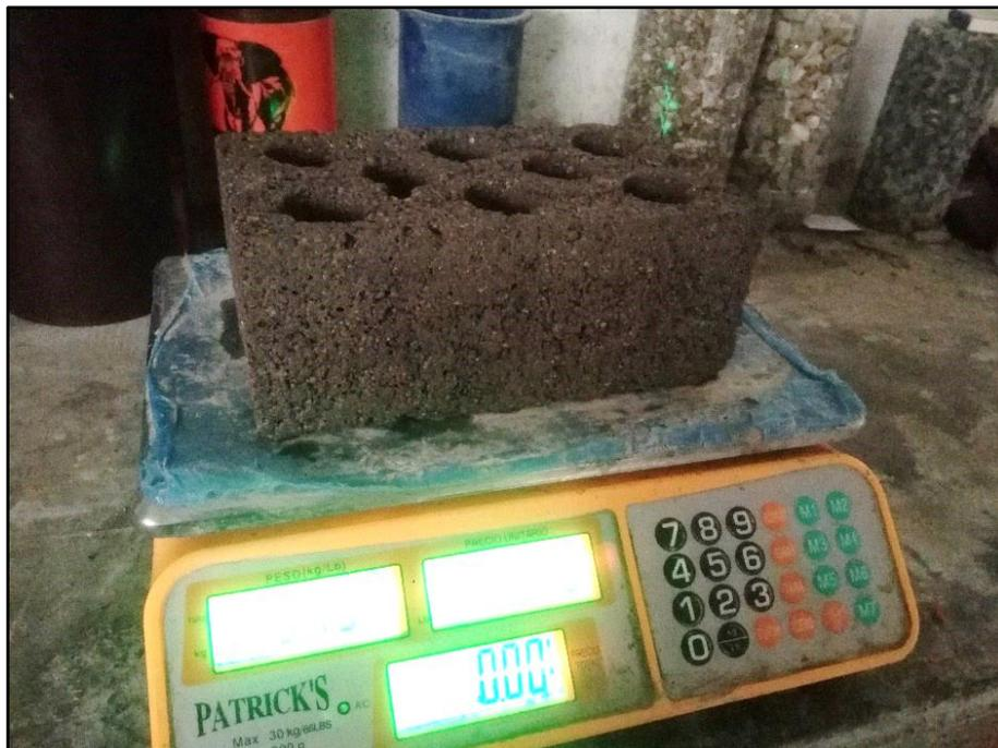
Foto 18. Ensayo de porcentaje de absorción
