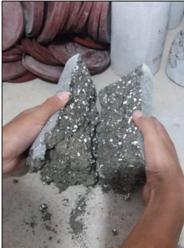
**Foto 10. Probeta de concreto sometidos a resistencia de compresión axial**
