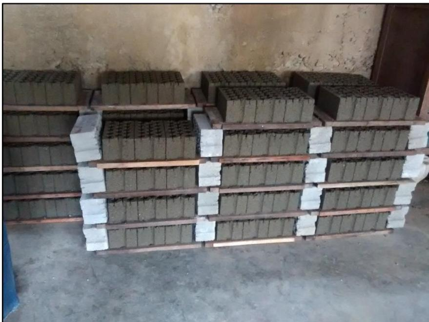
**Figura 73. Almacenado de ladrillos una vez curados, para poder ser ensayados**
