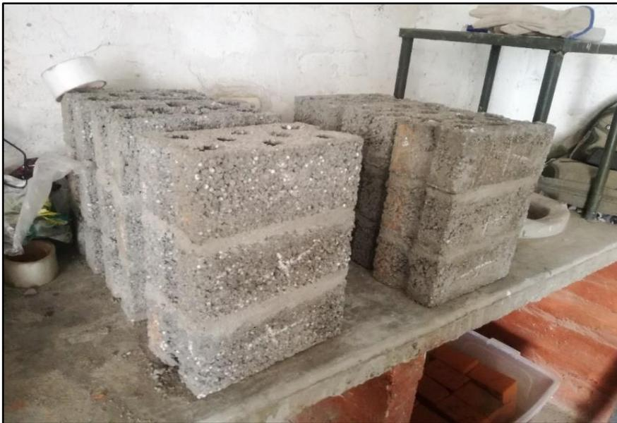
**Figura 88. Almacenado de pilas de ladrillos de concreto para ser roturados**
