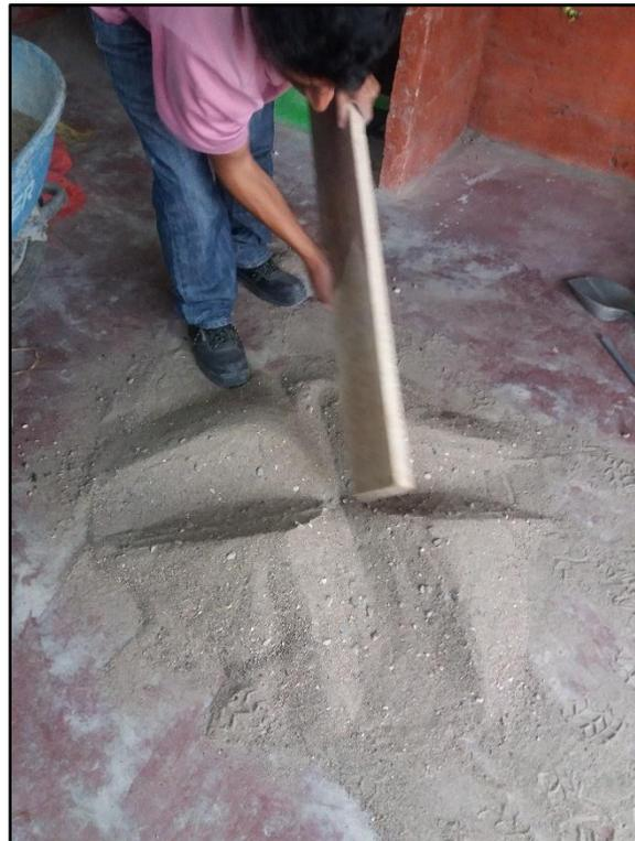
**Figura 34. Cuarteo de la muestra del agregado fino**
