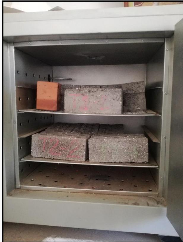
**Figura 80. Secado de las unidades de concreto en el horno eléctrico**
