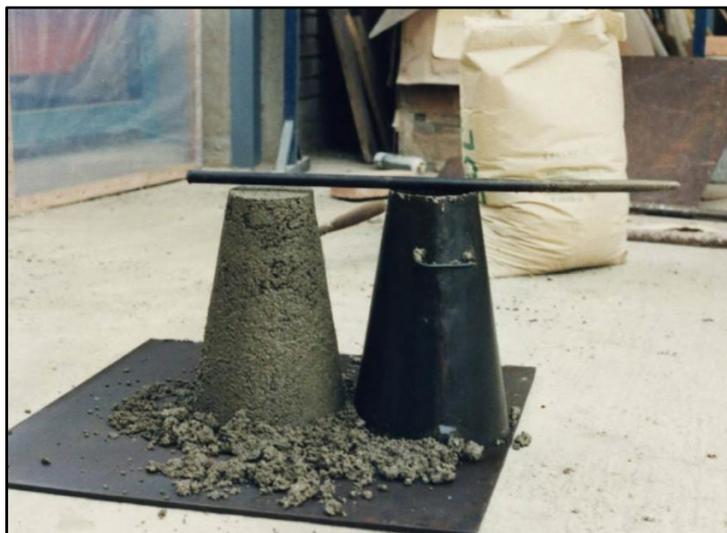
**Figura 16. Slump de 1 pulg., adecuada en la fabricación de ladrillos de concreto**
