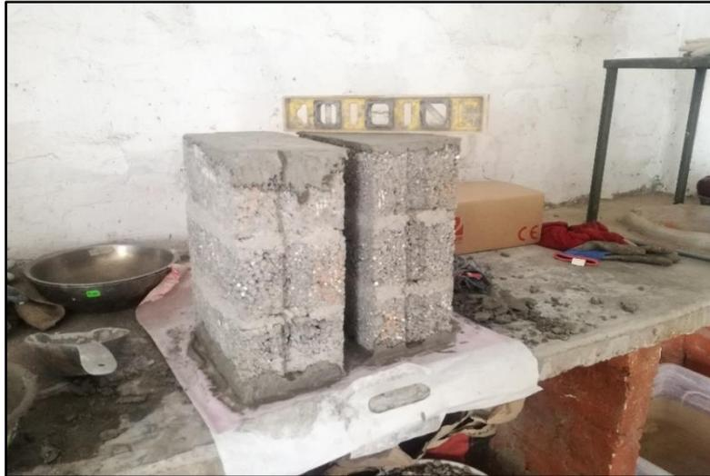
**Figura 89. Capping yeso – cemento de las pilas**
