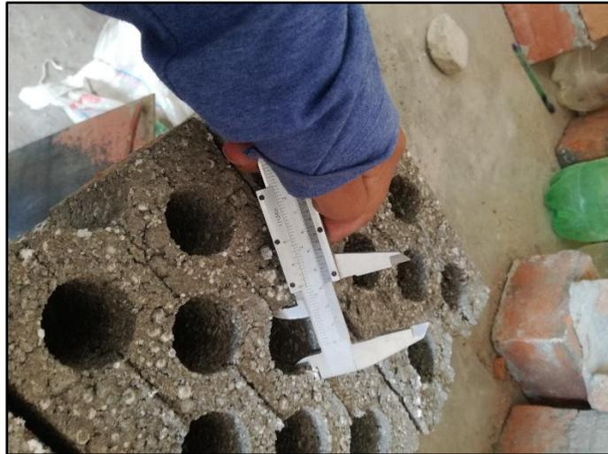
**Figura 83. Medición del área de vacíos que tiene la superficie de área de asiento**
