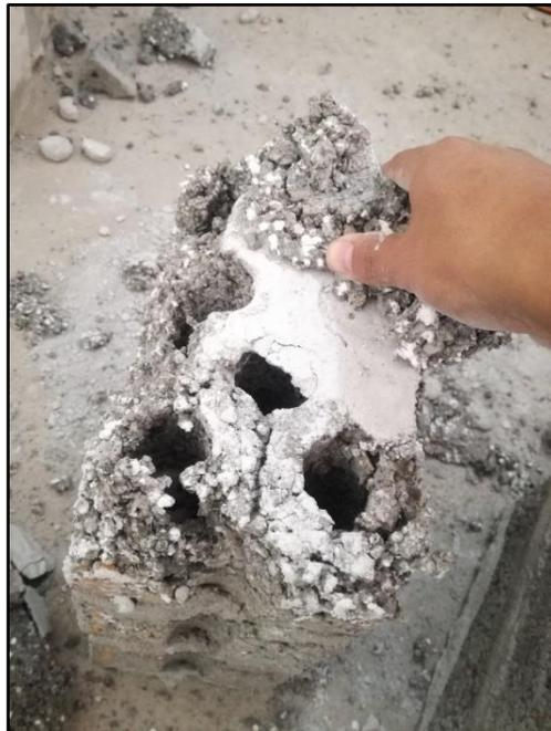
**Figura 103. Falla de Pila P5, por aplastamiento de unidades**
