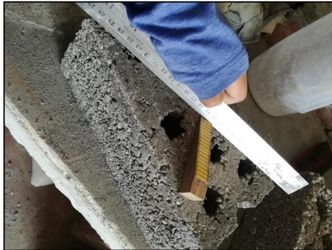
**Figura 77. Cuña graduada midiendo la concavidad de la unidad de concreto**
