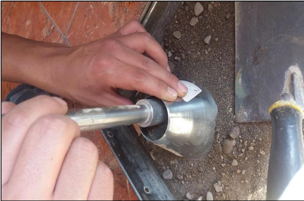
**Figura 41. Preparado de la muestra obteniendo material superficialmente seco del agregado fino**
