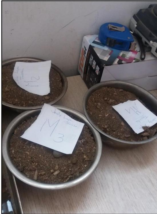
**Figura 46. Muestras de agregado fino de 1.5 kg cada una**
