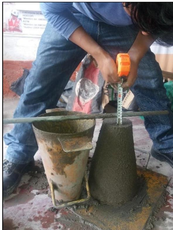
**Figura 54. Medición del slump, con un asentamiento de 1”**
