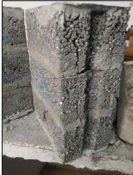
**Figura 102. Falla de Pila P4, por agrietamiento en el interior de las pilas**
