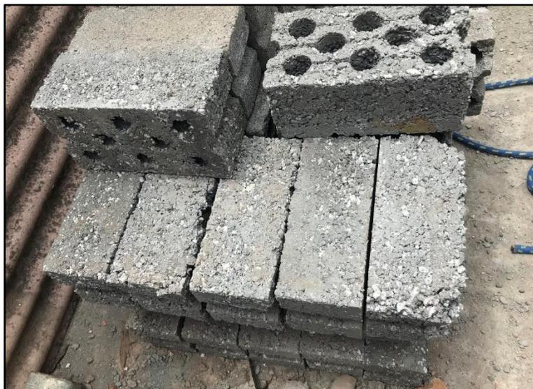
**Figura 106. Asentado en seco de las unidades de concreto con EPS**
