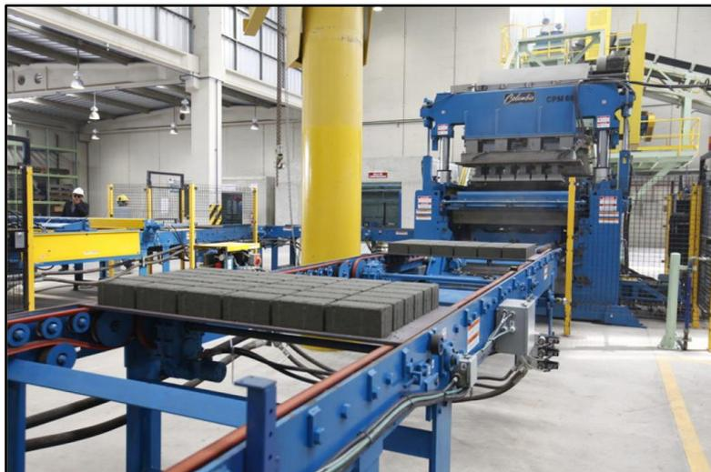
*Figura 21. Máquina Vibro-Compactadora estacionaria en procesos industriales*
