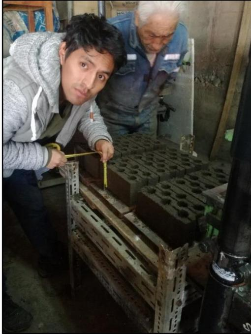
*Figura 71. Ladrillos de concreto, fabricados con la máquina vibradora
