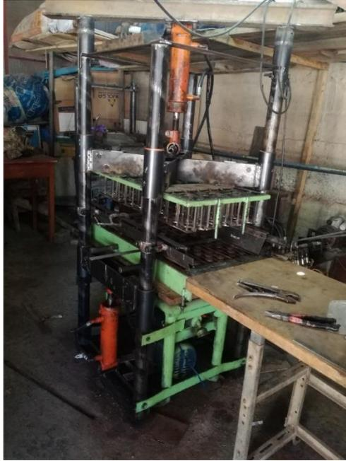
**Figura 69. Máquina vibradora de unidades de concreto**
