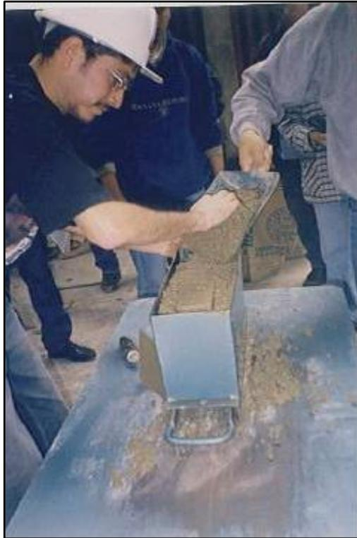
**Figura 18. Moldeo en artesanal de concreto, bloques de concreto**
