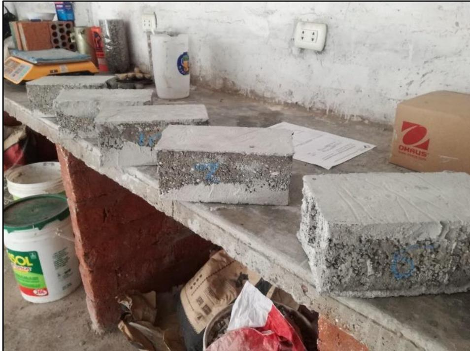
**Figura 78. Capping de las unidades de concreto**
