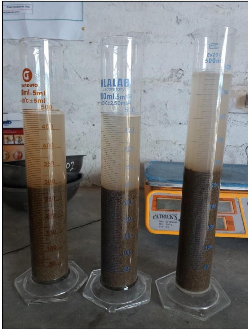
**Figura 43. Expulsión del aire restante atrapado dentro de la probeta**
