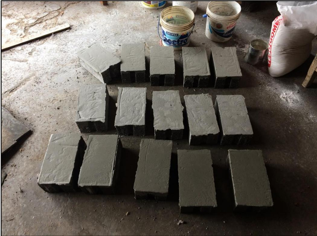
**Foto 15. Capping de yeso-cemento sobre las unidades de concreto**
