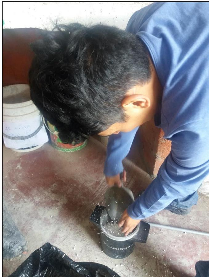
**Foto 4. Ensayo de peso unitario suelto del poliestireno expandido**
