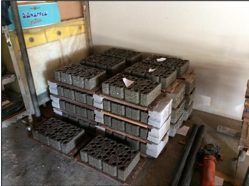
**Figura 72. Curado de las unidades de concreto con poliestireno expandido**
