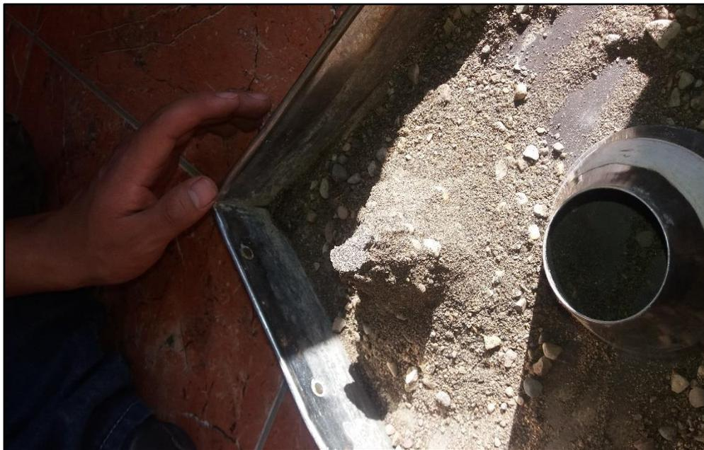
**Figura 42. Derrumbe del molde de agregado fino después de ejecutar 25 golpes, listo para ser pesado**
