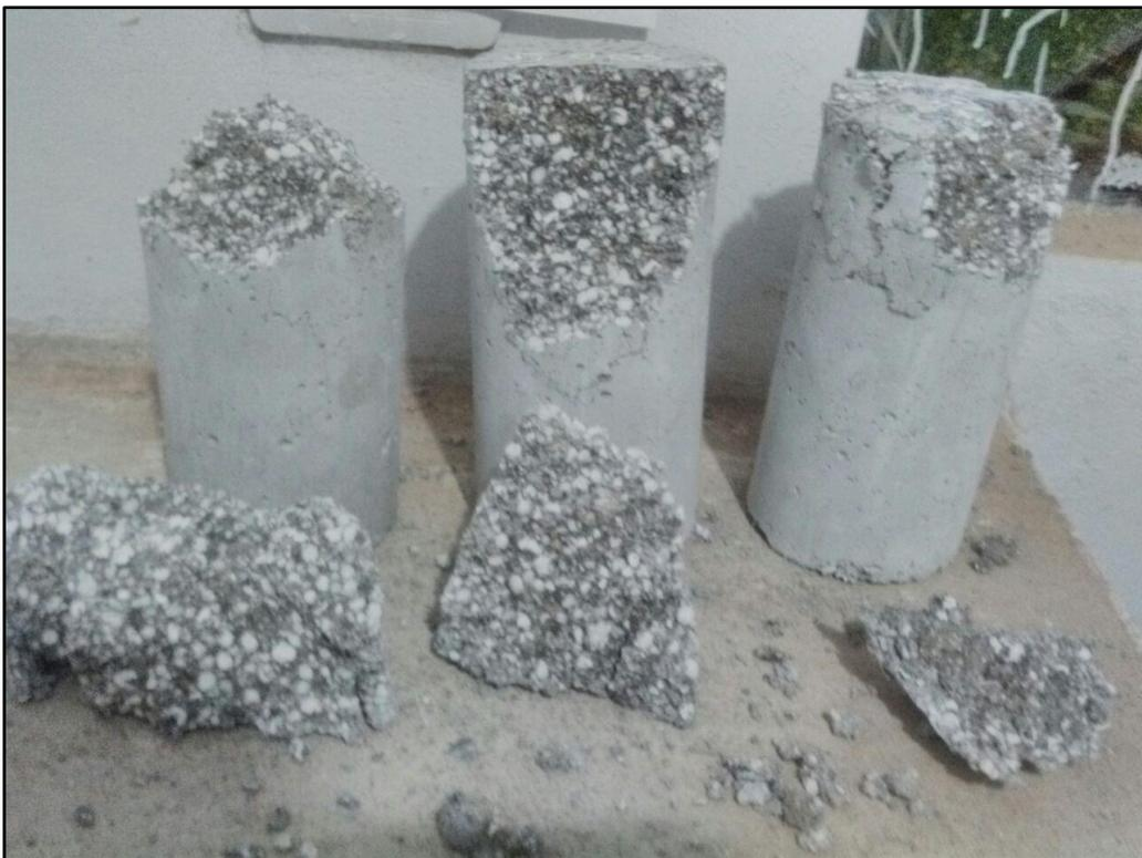
**Figura 65. Probetas con adición de poliestireno expandido roturadas**
