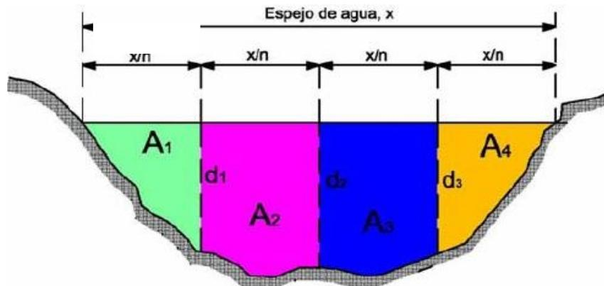
b) En cada sección se debe medir el ancho de sección y la profundidad
