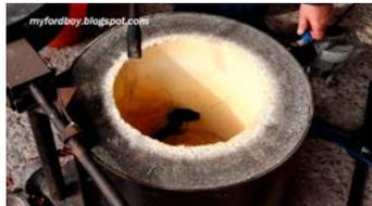
Se calienta el horno para colocar luego el crisol con la materia prima aluminio y estaño.
