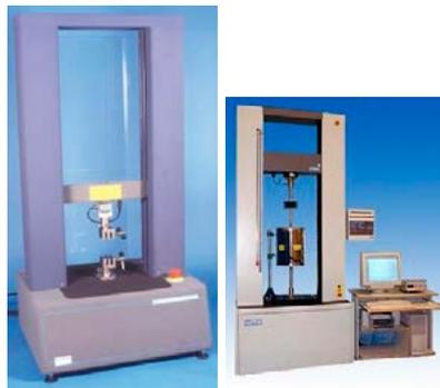
La probeta a ensayar se sujeta por sus extremos al cabezal móvil de la máquina de ensayos y a la célula de carga, respectivamente.
