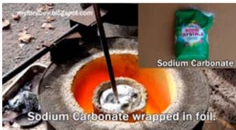
Agregando carbonato de sodio como fundente.
