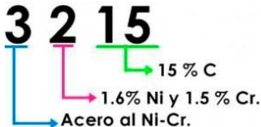
En la tabla 5.1 podemos encontrar una completa comparación entre las normas AISI, SAE y UNS para la clasificación de aceros con aleantes. No obstante, la composición de los aceros no es exacta, sino existe un rango de tolerancia aceptable en referencia a los valores indicados en normas o catálogo.
