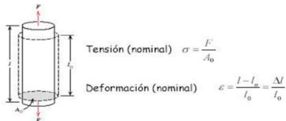
De tal forma que la curva típica sería tensión vs. deformación, tal y como se muestra en la figura 10.
