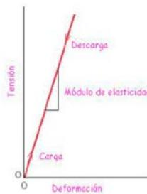
La pendiente de este segmento lineal corresponde al módulo de elasticidad E. Este módulo puede ser interpretado como la rigidez, o sea, la resistencia de un material a la deformación elástica. Cuanto mayor es el módulo, más rígido es el material, o sea, menor es la deformación elástica que se origina cuando se aplica una determinada tensión.
