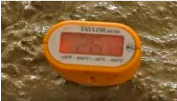
Figuras 1 y 2: Uso de diversos termómetros en la mezcla para medir la temperatura.
