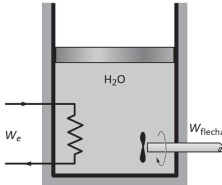
10. Cuatro kilogramos de agua se encuentran inicialmente a 10 bar, con un volumen inicial de  $V = 0.194349 \text{ m}^3$ . Experimenta una expansión isobárica hasta que su volumen específico sea  $0.2060 \text{ m}^3/\text{kg}$  determine:
