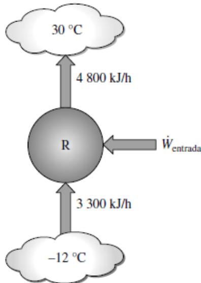
10. Un refrigerador doméstico con un COP de 1.2 quita calor del espacio refrigerado a una tasa de  $60\text{ kJ/min}$ . Determine a) la potencia eléctrica que consume el refrigerador y b) la tasa de transferencia de calor al aire de la cocina.
