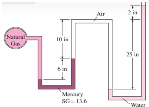
23. Una línea de gasolina está conectado a un manómetro de presión a través de una doble U-manómetro, como se muestra en la Fig. si la lectura de la galga de presión es 370 kPa, determinar la presión manométrica de la línea de la gasolina.
