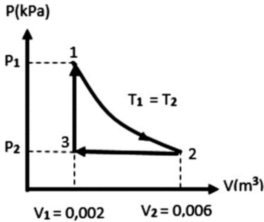
20. Se tiene un gas ideal que realiza un ciclo tal como se muestra en la figura. Determine el calor neto conociendo que el calor entregado en el proceso isotérmico es de 80 J.
