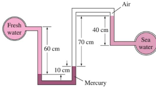
21. La presión relativa del aire en el depósito se muestra en la Figura se midió y resulta 80 kPa. Determinar el desnivel de altura  $h$  de la columna de mercurio.
