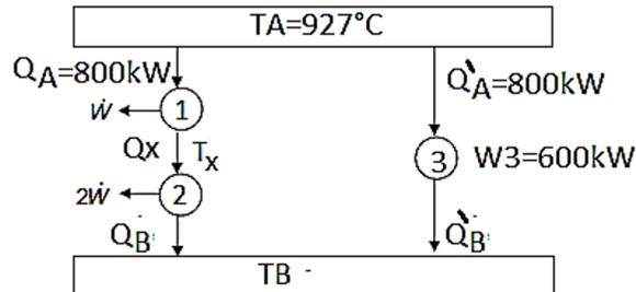
6. La figura muestra la máquina térmica reversible que trabaja como bomba de calor, si:
