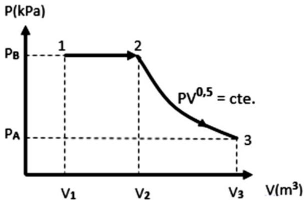
19. Se tiene un gas ideal que realiza un ciclo tal como se muestra en la figura. Determine el calor neto conociendo que el calor entregado en el proceso isotérmico es de 80 J.
