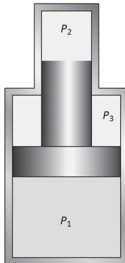
17. Los diámetros del émbolo en la figura anterior son  $D_1 = 10 \text{ cm}$  y  $D_2 = 4 \text{ cm}$ . Cuando la presión en la cámara 2 es 2000 kPa y la presión en la cámara 3 es 700 kPa, ¿cuál es la presión en la cámara 1, en kPa? Respuesta: 908 kPa.
