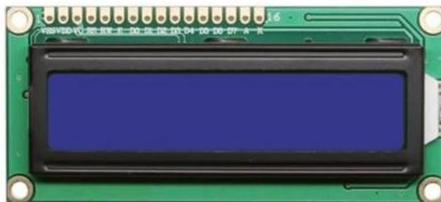
Figura 29. Display LCD 16x2
