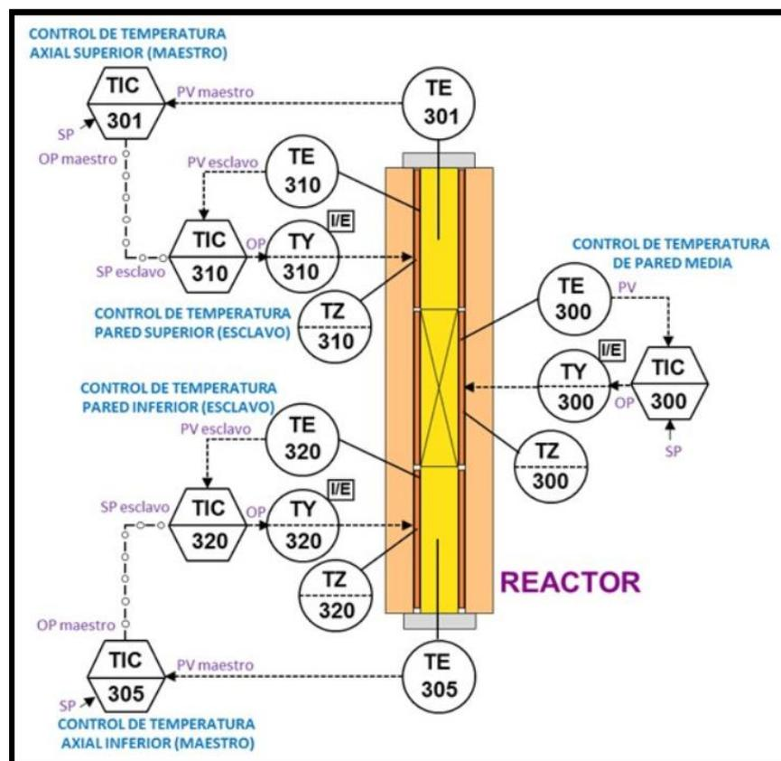
Figura 13. Estrategia de control de temperatura de las tres zonas: control en cascada temperatura axial-temperatura de pared en las zonas superior e inferior y control de temperatura de pared en la zona media.
