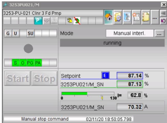
Figura 44 Faceplate de bloque motor de PU-021
