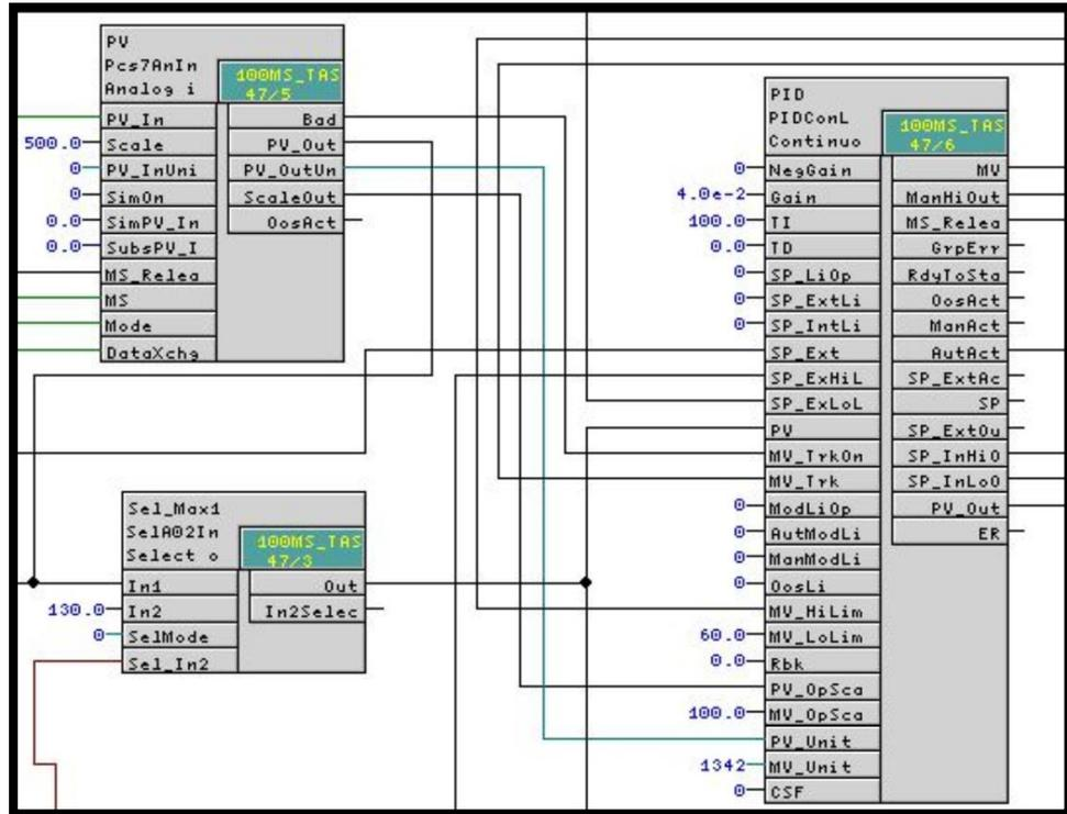
Figura 39. Bloque PID de control de flujo
