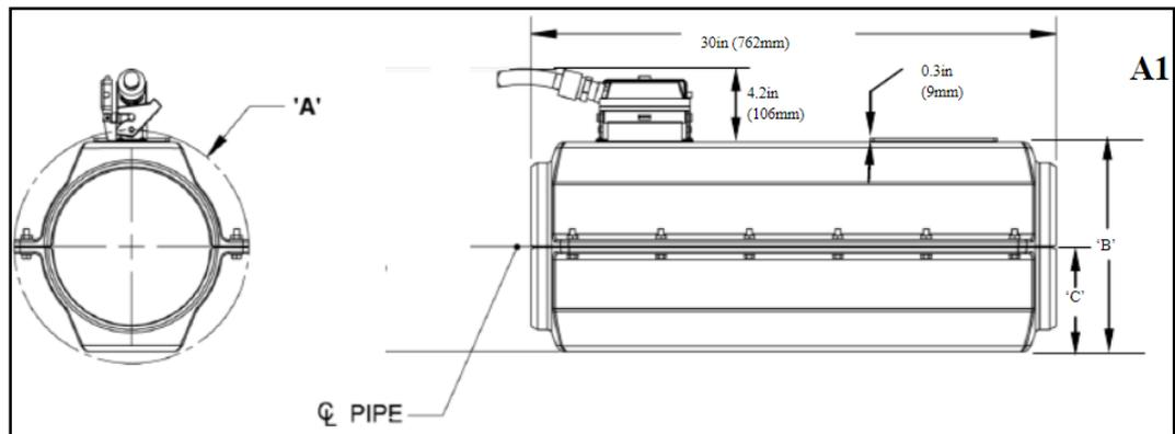
Figura 60. Flujómetro SONARtrac
