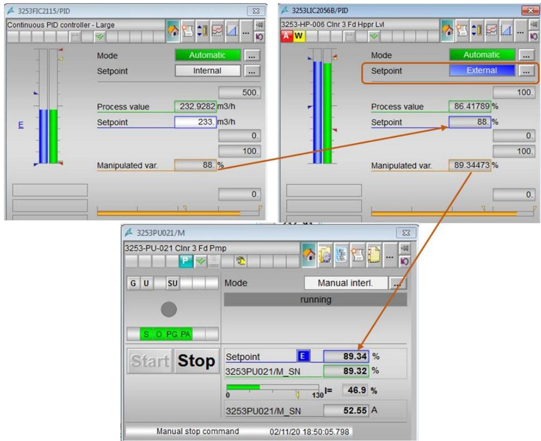
Figura 46. Faceplate del control en cascada flujo - nivel
