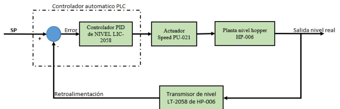
Figura 32. Diagrama de bloque PID de control de nivel HP-006
