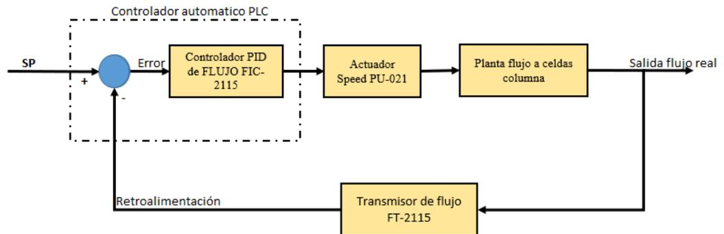
Figura 35. Diagrama de bloque PID de control de flujo a celdas columna
