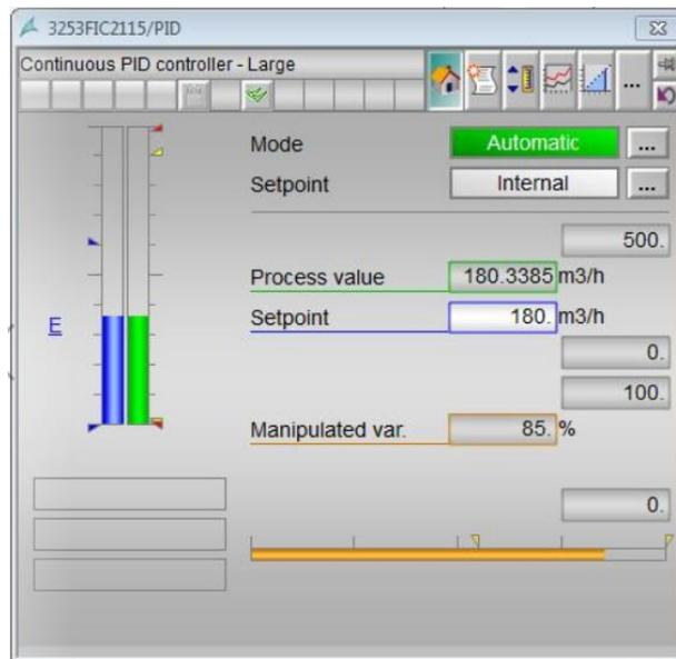
Figura 41 Faceplate de control PID de flujo
