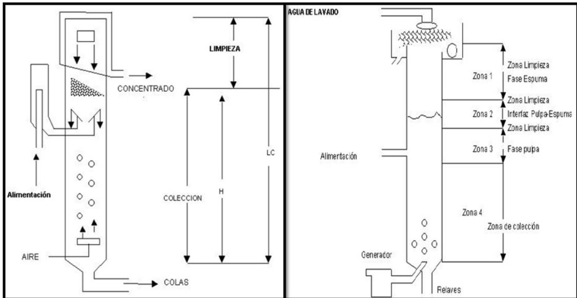
Figura 7. Celda columna y zonas de operación
