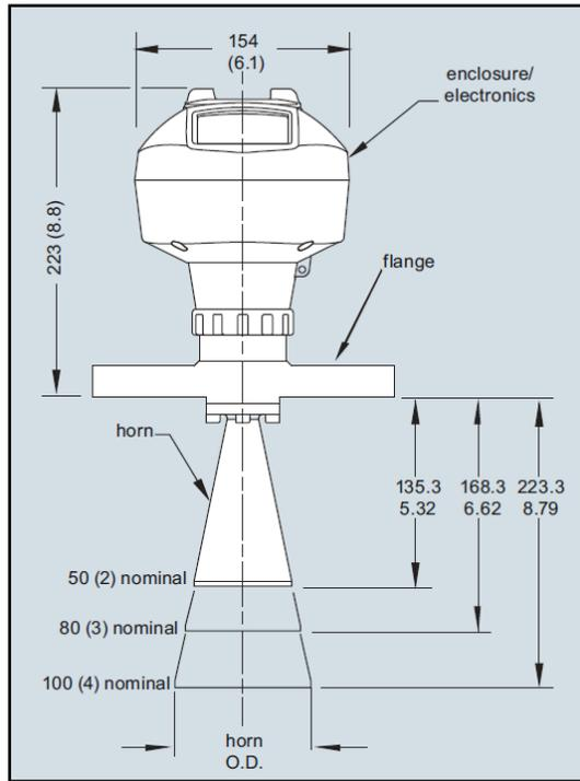
Figura 59. Dimensiones según tamaño de sensor
