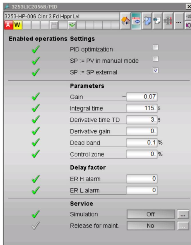
Figura 33. parámetros, proporcional, integral y derivativo del control de nivel
