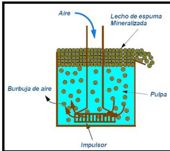
Figura 6. Flotación de espuma en celda mecánica
