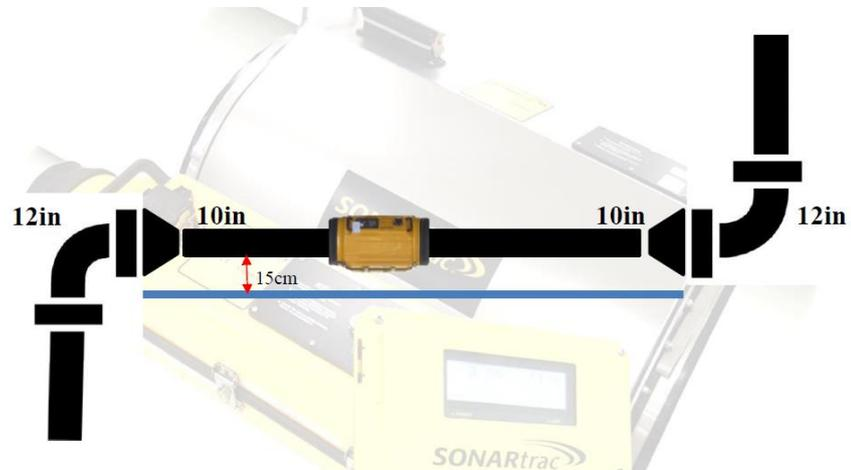
Figura 49. Reducción de tubería de 12" a 10"
