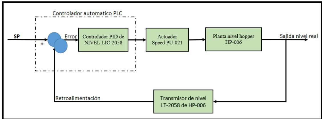
Figura 23. Diagrama PID actual, control de nivel
