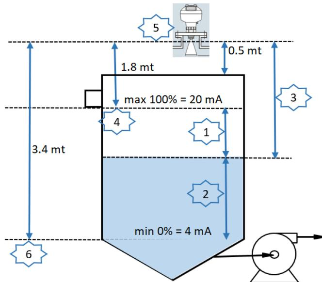
**Figura 26. Puntos de configuración de sensor de nivel**
