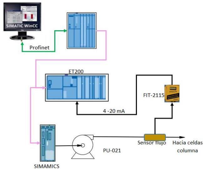
Figura 34. Arquitectura del sistema con control de flujo
