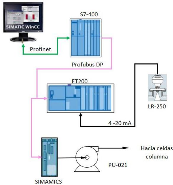
Figura 31 Arquitectura del sistema con control de nivel
